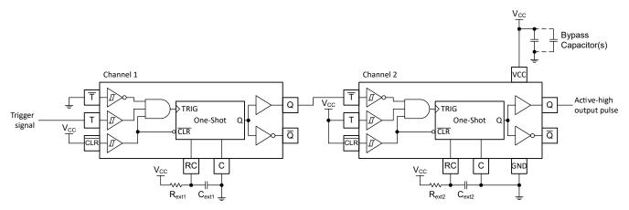
図 8-4. TPUL2G123-Q1 を使用した遅延パルス生成回路図
