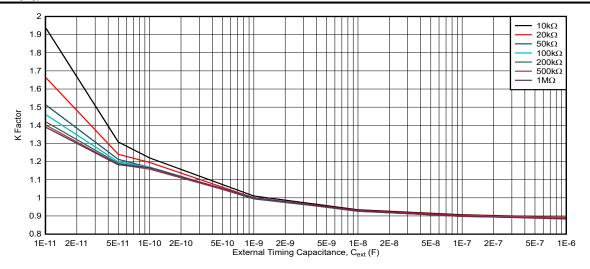
図 5-15. K 係数、 $V_{CC}$  = 3.3V、 $R_{ext}$  = 10kΩ  $\sim$  1MΩ
