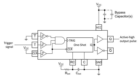
図 8-1. TPUL2G123-Q1 を使用したパルス ジェネレータの回路図
