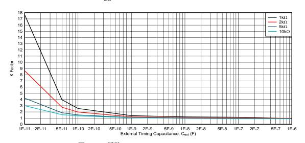
図 5-8. K 係数、 $V_{CC}$  = 1.5V、 $R_{ext}$  = 1kΩ  $\sim$  10kΩ
