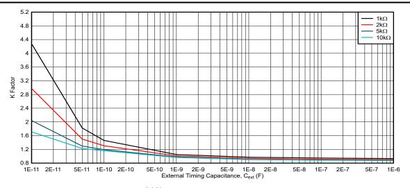
図 5-18. K 係数、 $V_{CC}$  = 5.5V、 $R_{ext}$  = 1 $k\Omega$  ~ 10 $k\Omega$
