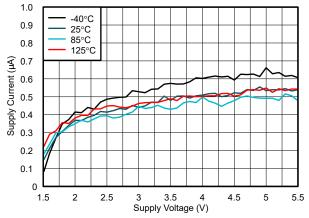
図 5-2. 電源電流と電源電圧との関係
