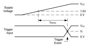
図 6-8. 電圧波形、起動時間
