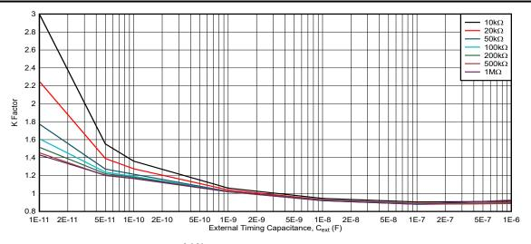
図 5-9. K 係数、 $V_{CC}$  = 1.5V、 $R_{ext}$  = 10k $\Omega$  ~ 1M $\Omega$
