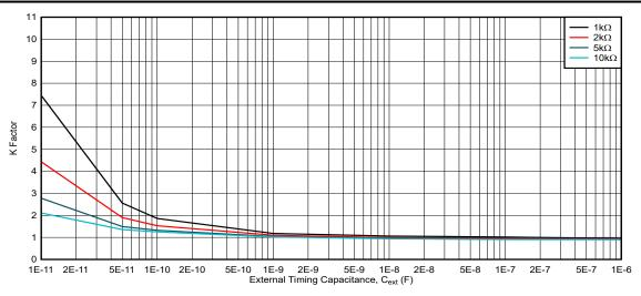
図 5-12. K 係数、 $V_{CC}$  = 2.5V、 $R_{ext}$  = 1k $\Omega\sim 10$ k $\Omega$
