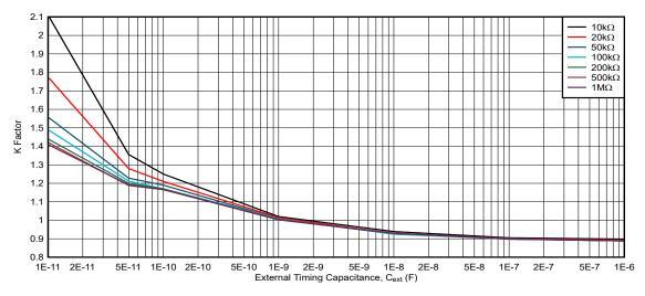
図 5-13. K 係数、 $V_{CC}$  = 2.5V、 $R_{ext}$  = 10 $k\Omega$  ~ 1 $M\Omega$
