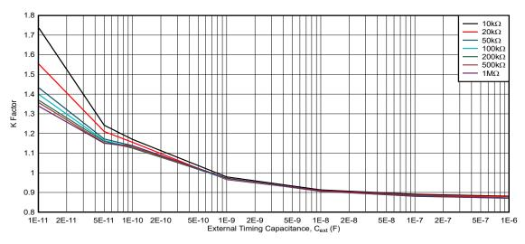
図 5-17. K 係数、 $V_{CC}$  = 5V、 $R_{ext}$  =  $10k\Omega\sim 1M\Omega$
