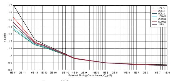
図 5-19. K 係数、 $V_{CC}$  = 5.5V、 $R_{ext}$  = 10 $k\Omega\sim 1$ MΩ
