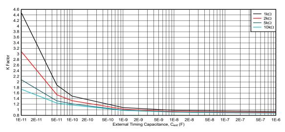
図 5-16. K 係数、 $V_{CC}$  = 5V、 $R_{ext}$  = 1kΩ  $\sim$  10kΩ
