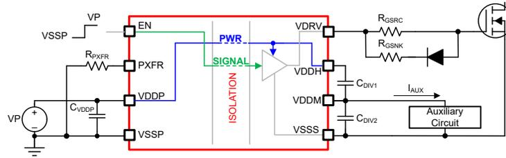
図 8-3. VDDM からの補助電源の供給
