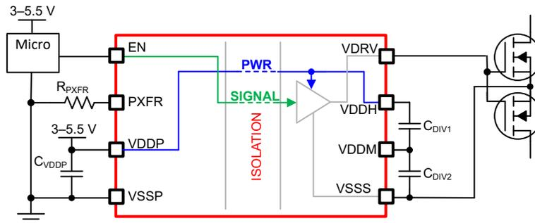
図 7-1. 3 線式モードの概略回路図
