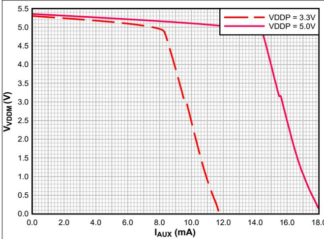
図 5-14.  $V_{VDDM}$  と  $I_{AUX}$  の比較
