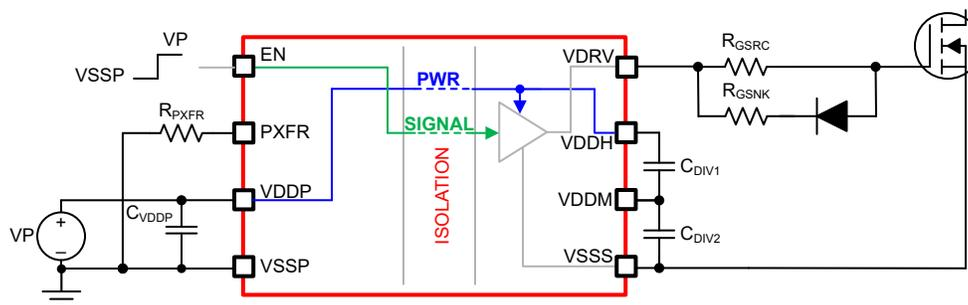
図 8-1. TPSI3050M 3 線式モード駆動 MOSFET
