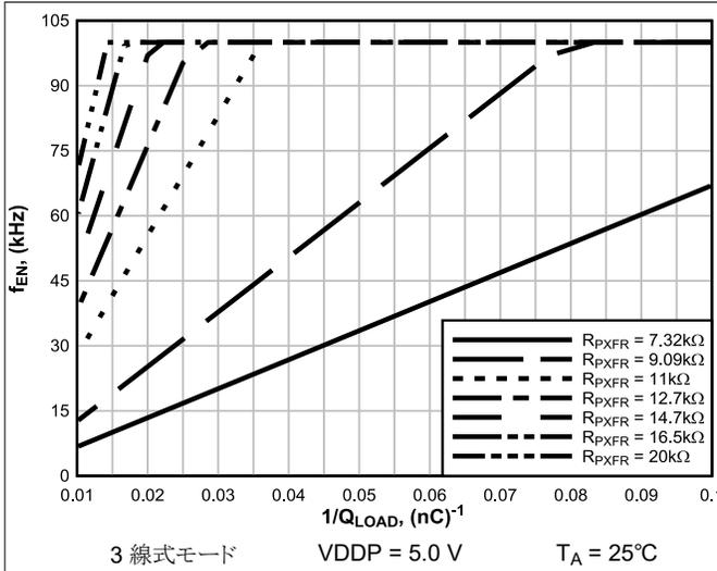
図 5-12. 最大の  $f_{EN}$  と  $Q_{LOAD}$  の比較 = 10nC ~ 100nC
