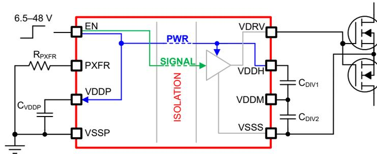
図 7-3. 2 線式モードの概略回路図
