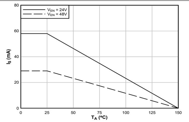
図 5-2.2 線式モードの VDE および IEC に従う制限電流の熱特性低下曲線
