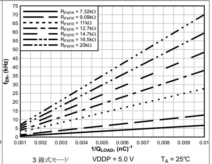
図 5-13. 最大の  $f_{EN}$  と  $Q_{LOAD}$  の比較 = 100nC ~ 1000nC
