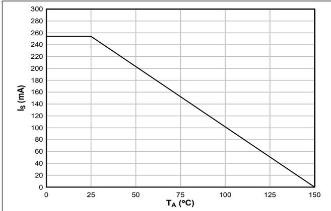
図 5-1.3 線式モードの VDE および IEC に従う制限電流の熱特性低下曲線
