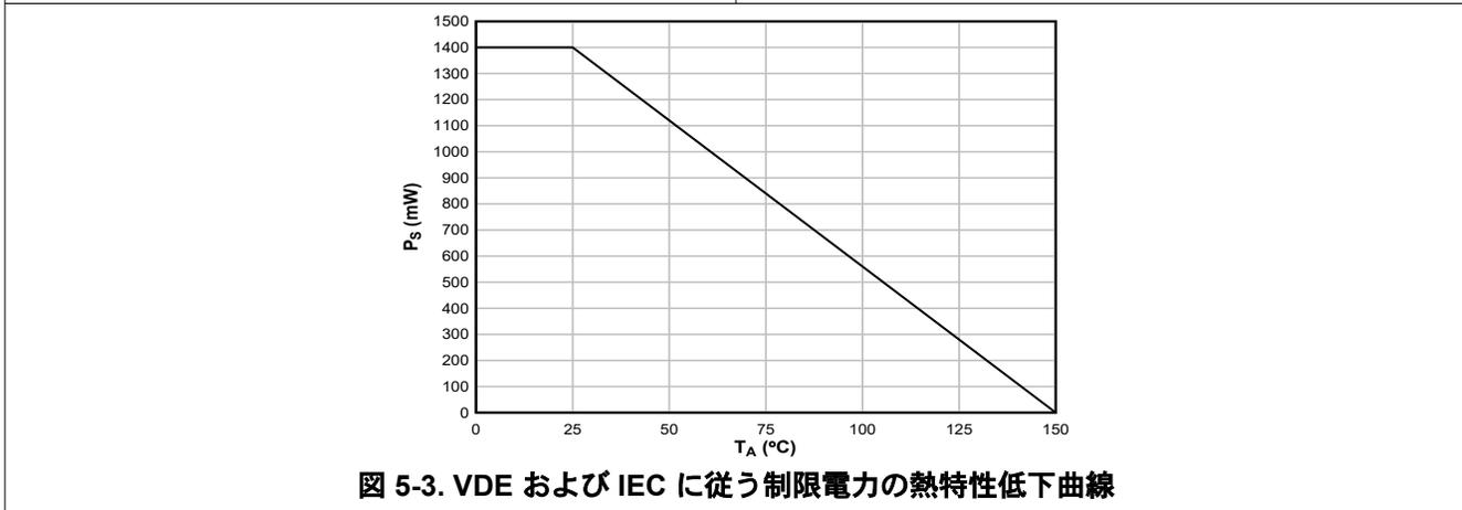
図 5-3. VDE および IEC に従う制限電力の熱特性低下曲線
