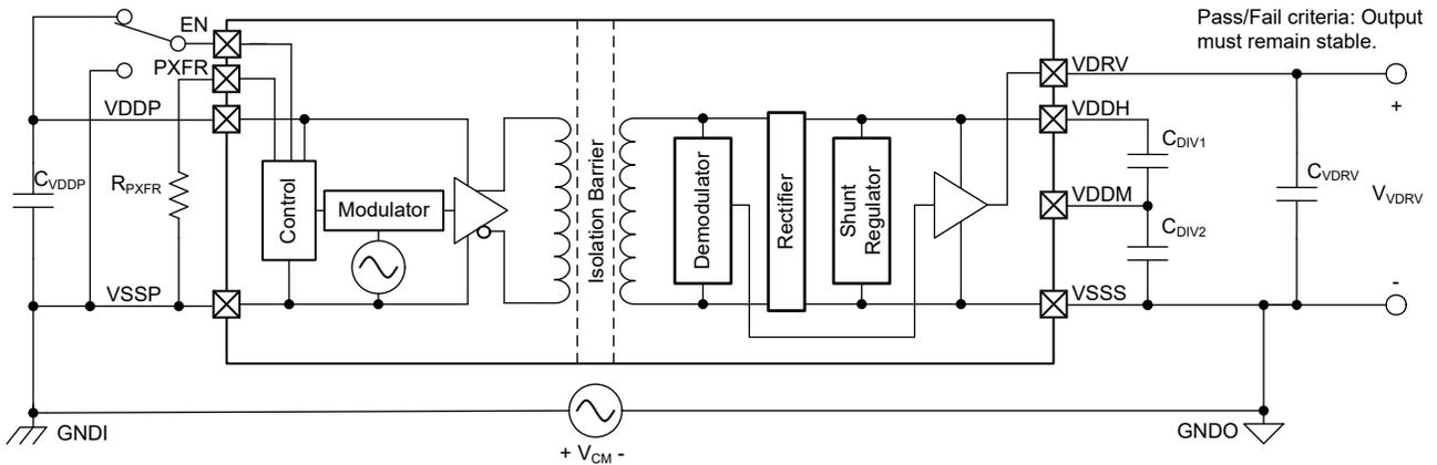
図 6-3. 同相過渡電圧耐性試験回路
