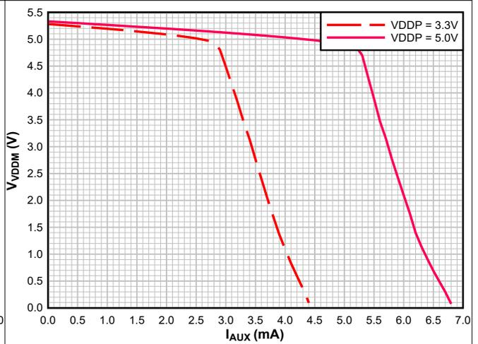
図 5-15.  $V_{VDDM}$  と  $I_{AUX}$  の比較
