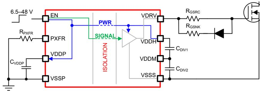
図 8-2. TPSI3050M 2 線式モード駆動 MOSFET
