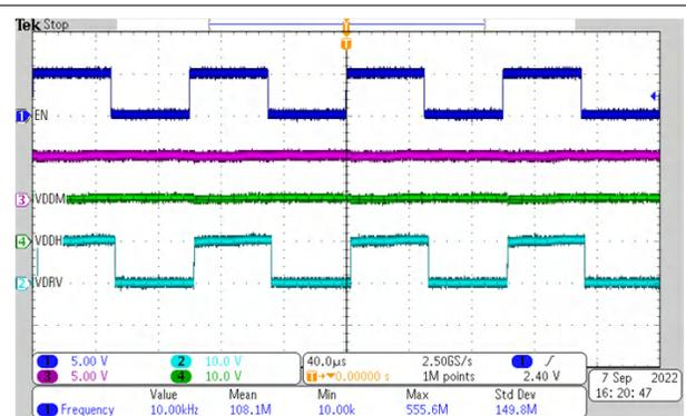
3 線式モード VDDP = 5.0 V  $R_{PXFR} = 12.7k\Omega$
