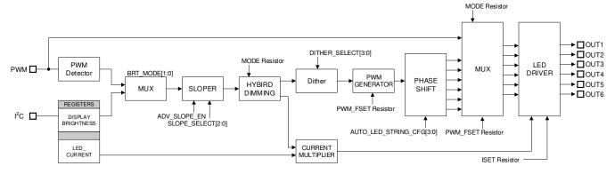
図 7-9. TPS92391 Brightness Path Diagram
