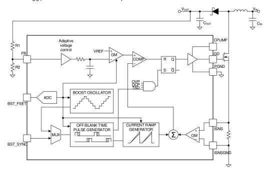
図 7-3. Boost Controller Block Diagram
