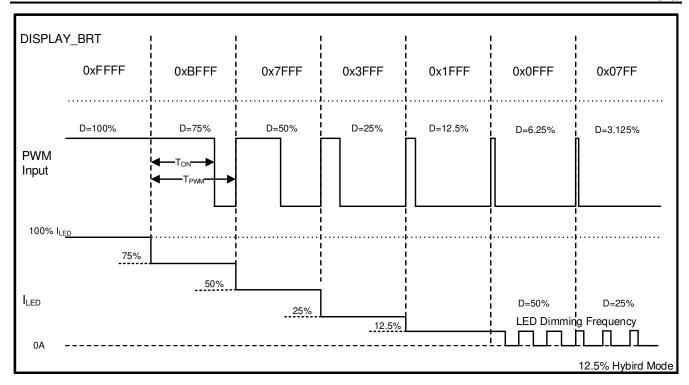
図 7-11. Hybrid Dimming Diagram
