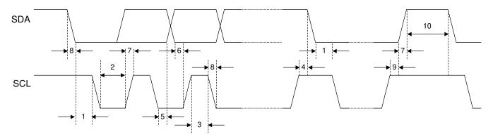
図 6-1. I2C Timing Diagram
