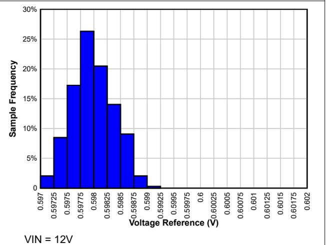
図 6-50.  $T_A = -55^\circ\text{C}$  での出力電圧の精度分布
