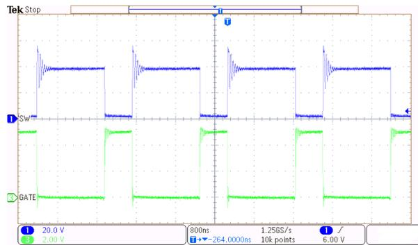
図 8-4. ゲートおよびスイッチ ノード信号
