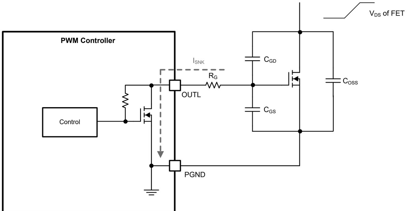
図 7-12. 電源なしの電圧クランプ
