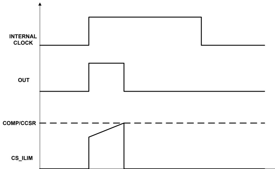
図 7-11. ピーク電流モード制御と PWM 生成
