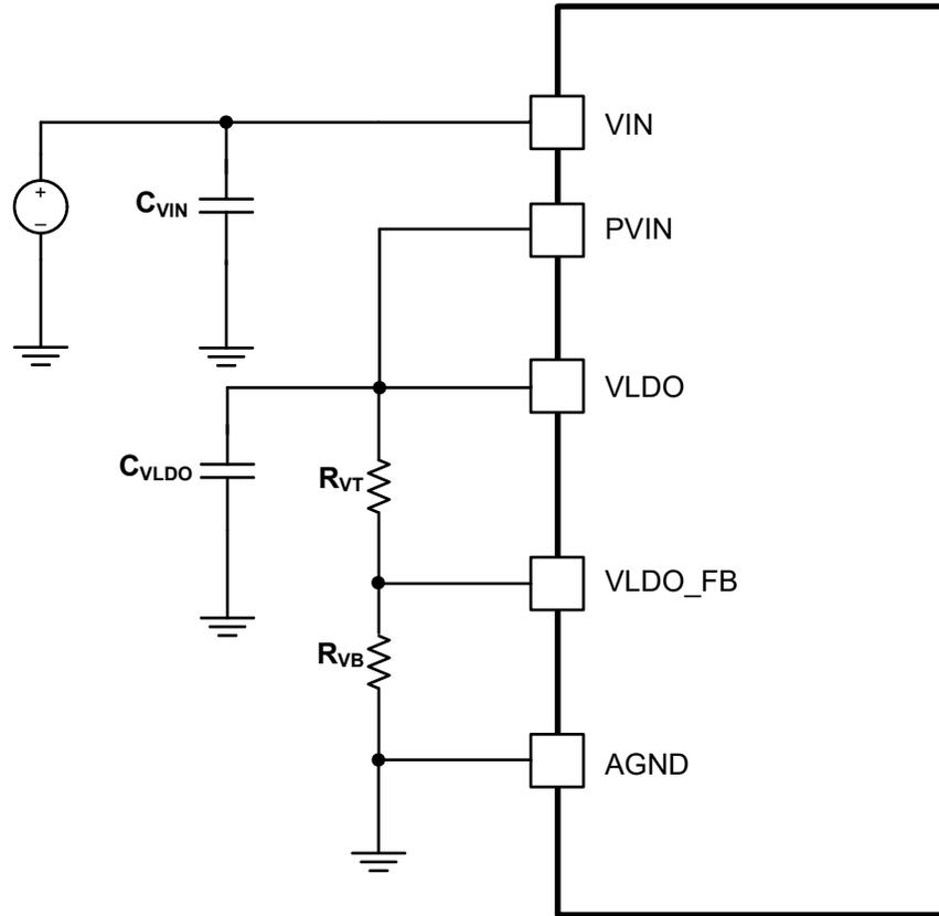
図 7-5. TPS7H502x の PVIN から VLDO への接続の構成
