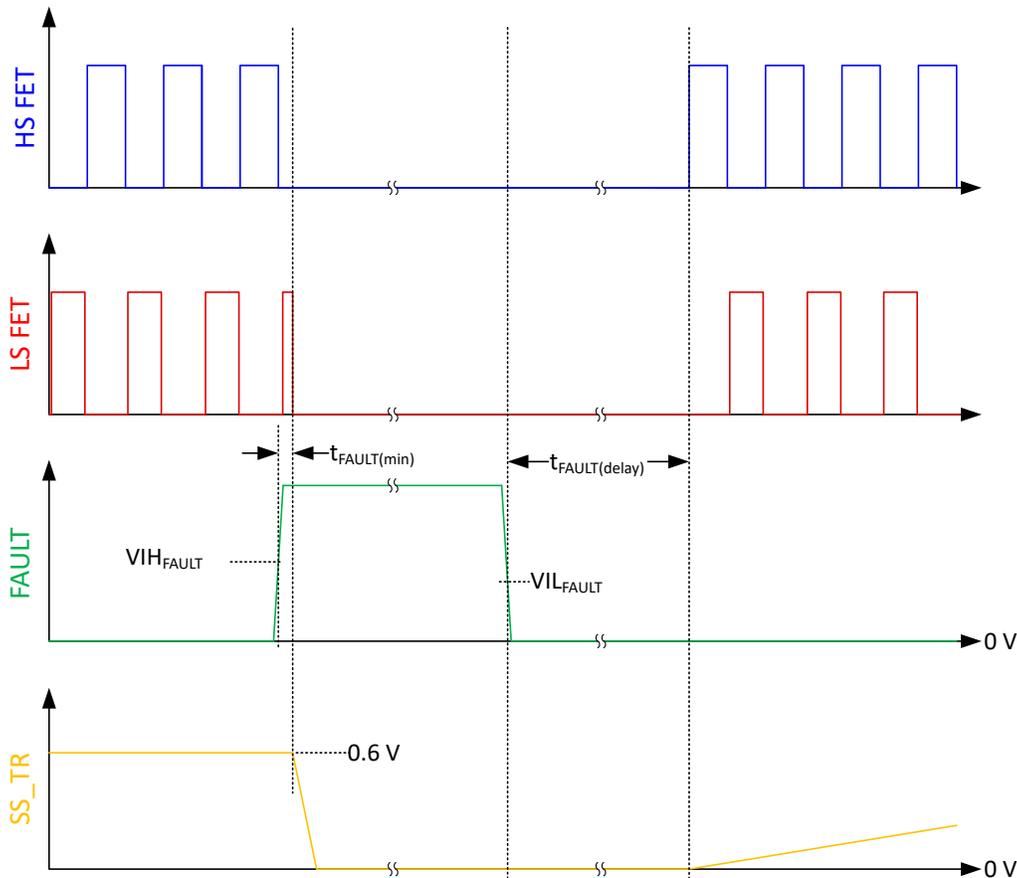
図 8-3. FAULT ピンの波形は外部信号です
