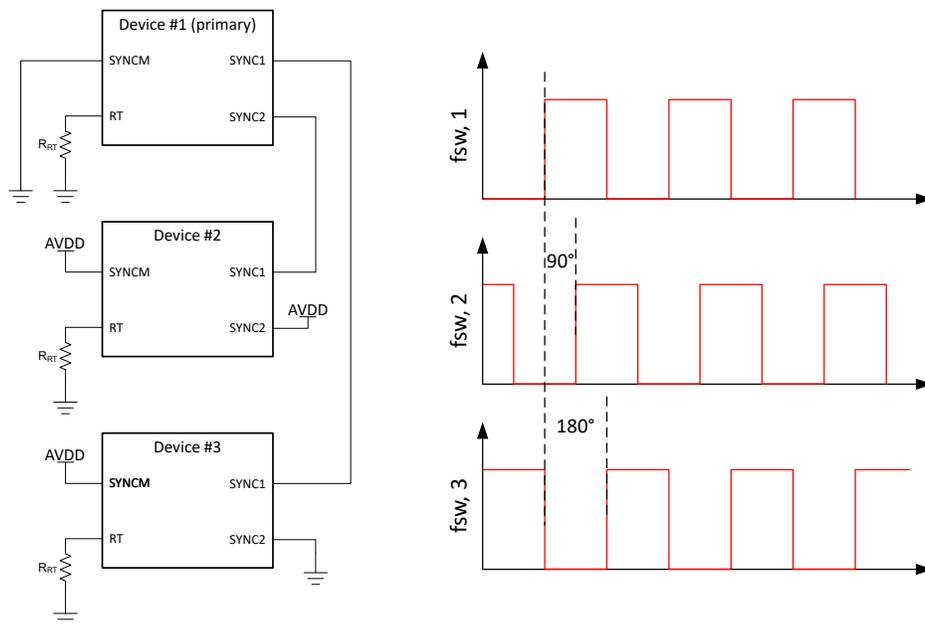
図 8-12. 3 台のデバイスによる並列動作
