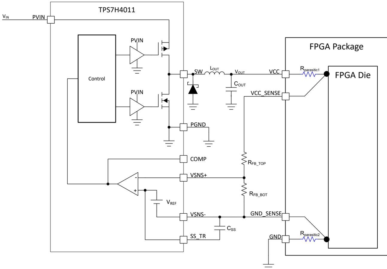
図 8-1. FPGA リモートセンスの例
