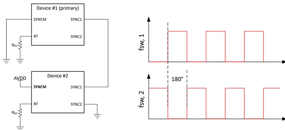
図 8-13. 2 台のデバイスによる並列動作
