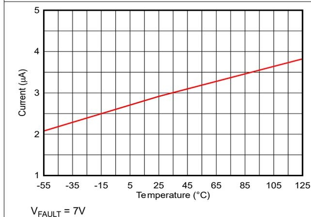
図 6-29. FAULT リーク電流と温度との関係
