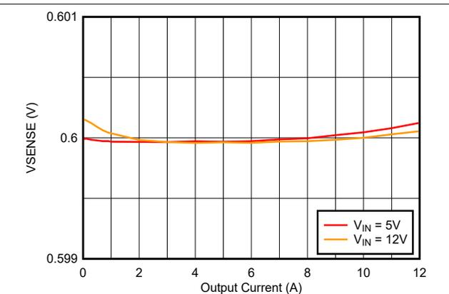
図 6-32. 500kHz での  $V_{SENSE}$  と出力電流との関係
