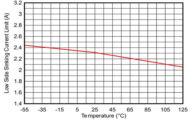
図 6-42. ローサイドシンク電流制限スレッショルド (I<sub>OC\_LS(sink)</sub>) と温度との関係
