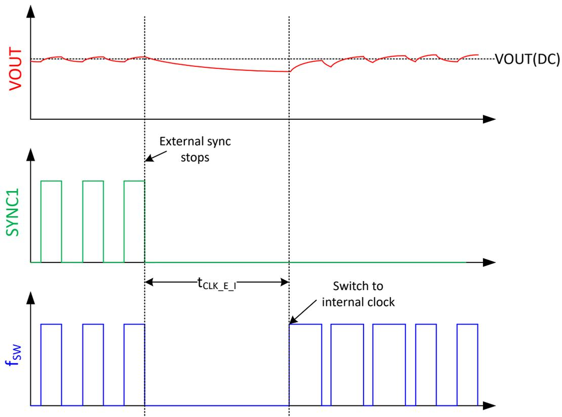
図 8-8. 外部から内部へのクロック遷移
