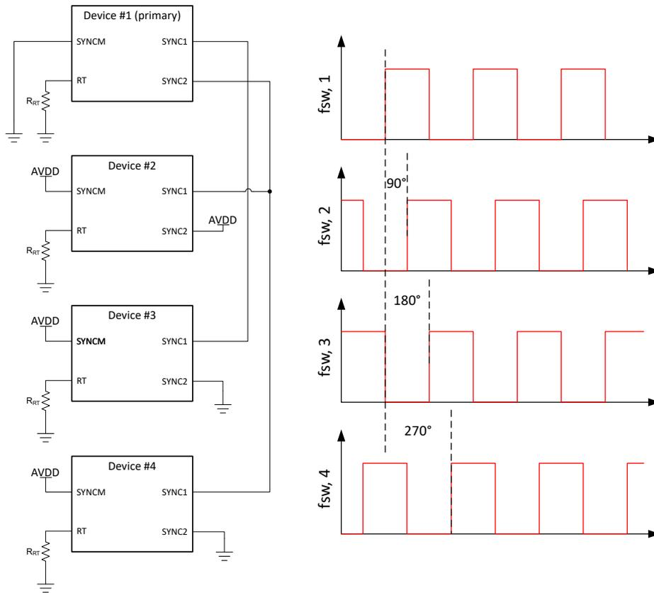
図 8-11. 4 台のデバイスによる並列動作
