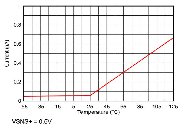
図 6-30.  $V_{SNS+}$  リーク電流と温度との関係
