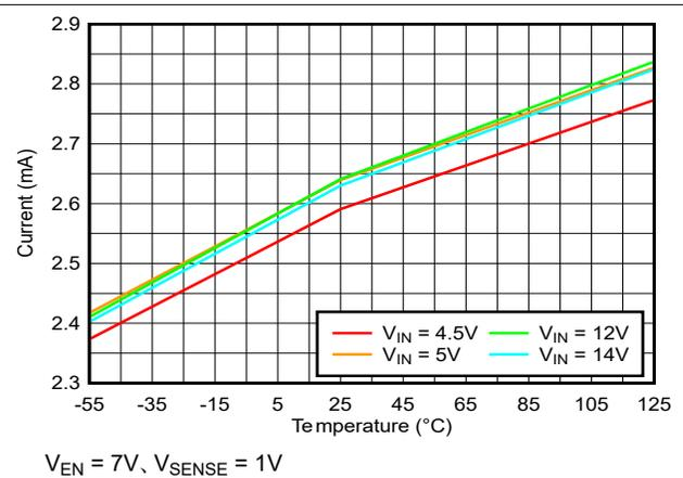
図 6-28.  $V_{IN}$  静止電流 (非スイッチング時) と温度との関係
