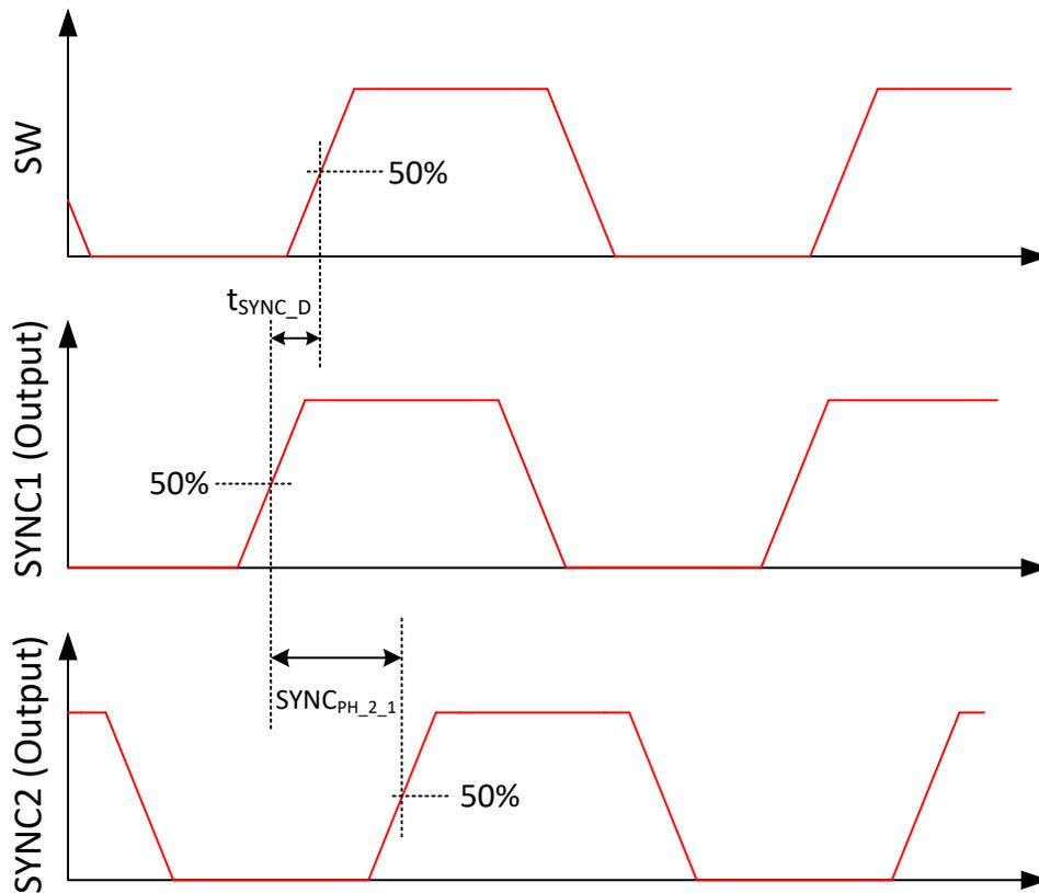
図 7-7. SYNC1 から SW への遅延：SYNC1 出力
