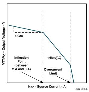
図 8-9. TPS7H3301-SP Impedance Characteristics
