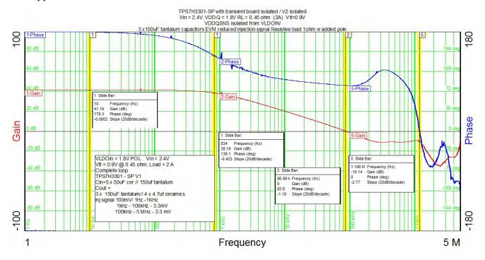
図 8-10. DDR2 2-A Load  $V_{IN}$  = 2.4 V, VTT/ $V_{O}$  = 0.9 V
