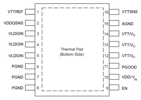
図 5-1. HKR Package, 16-Pin CFP (Top View)
