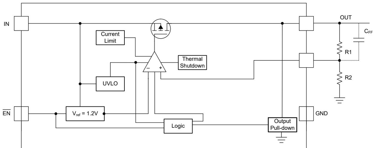
图 6-3. TPS76901-Q1 Functional Block Diagram (New Chip)
