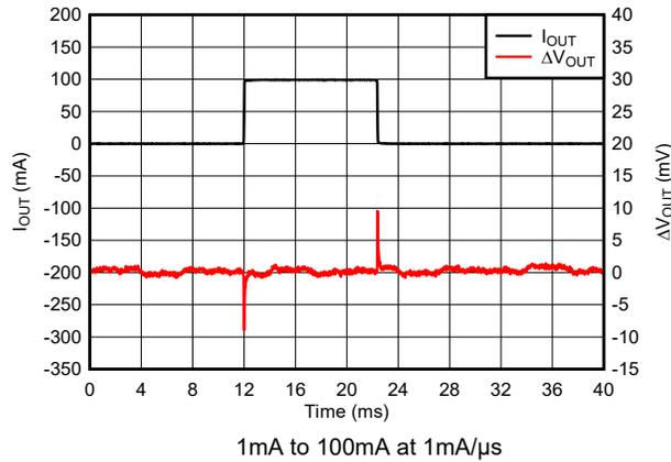
図 7-16. TPS76933-Q1 Load Transient Response (New Chip)
