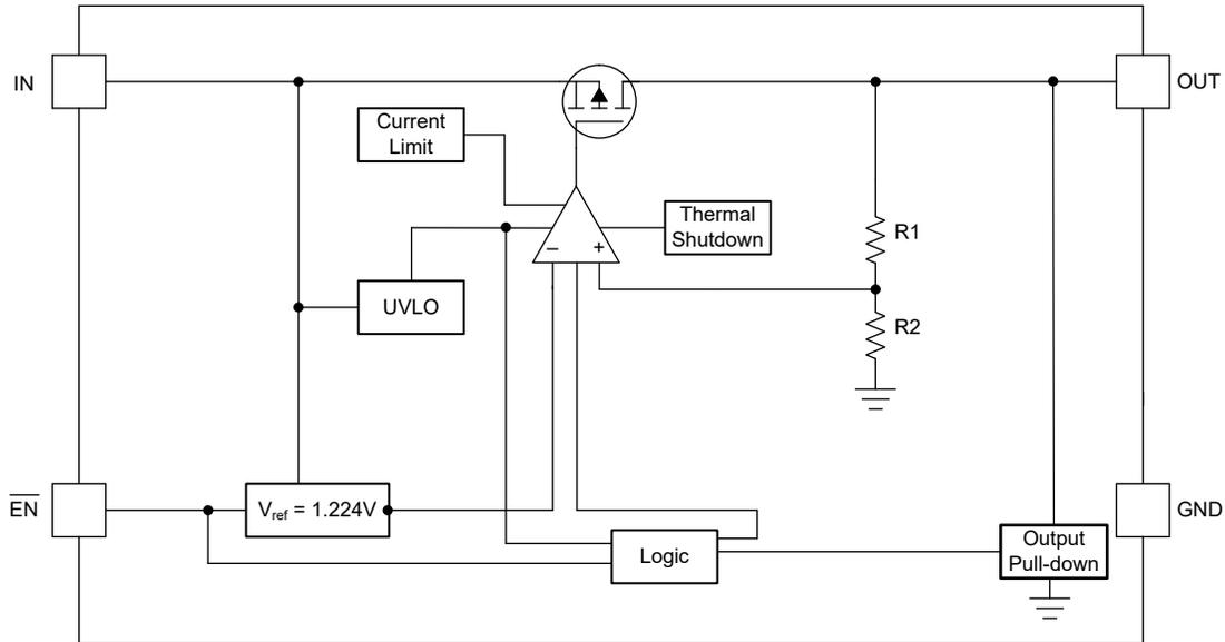
図 6-4. TPS769-Q1 Functional Block Diagram (New Chip)
