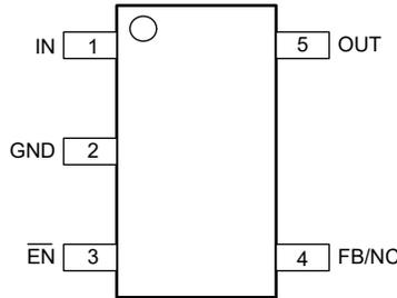
図 4-1. DBV Package, 5-Pin SOT-23 (Top View)
