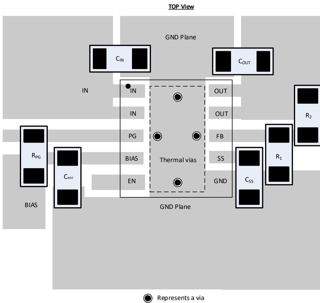
図 7-7. Layout Example: DRC Package
