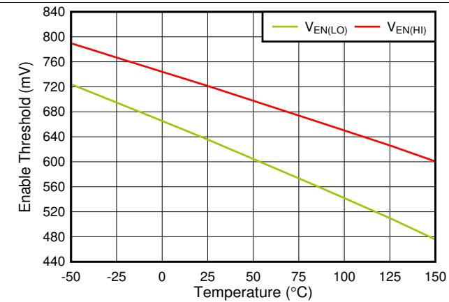
图 21. V<sub>EN(HI)</sub> and V<sub>EN(LO)</sub> vs Temperature
