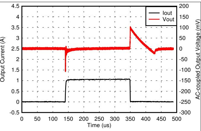
图 26. 1-mA to 1-A Load Transient (0.55 V)
