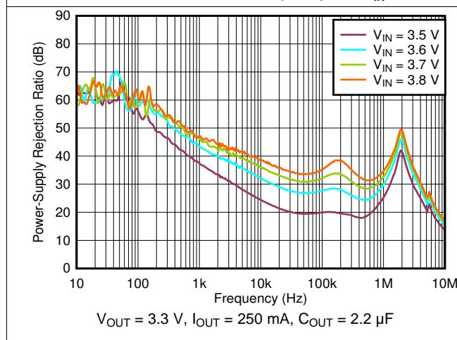
図 33. PSRR vs Frequency and  $V_{\text{IN}}$
