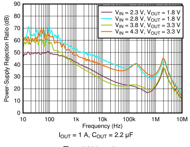
図 36. PSRR vs Frequency
