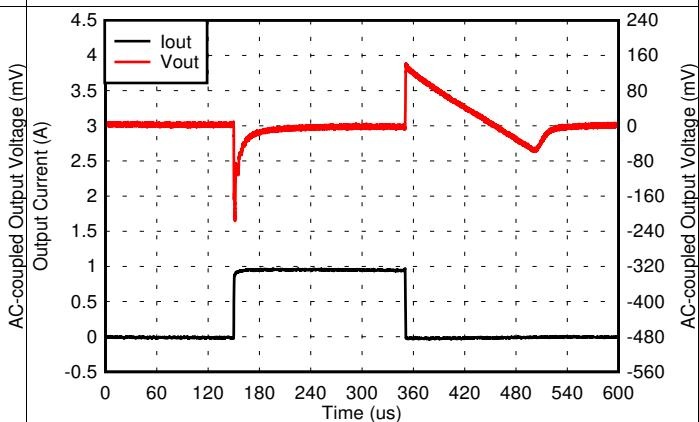
图 28. 1-mA to 1-A Load Transient (3.3 V)
