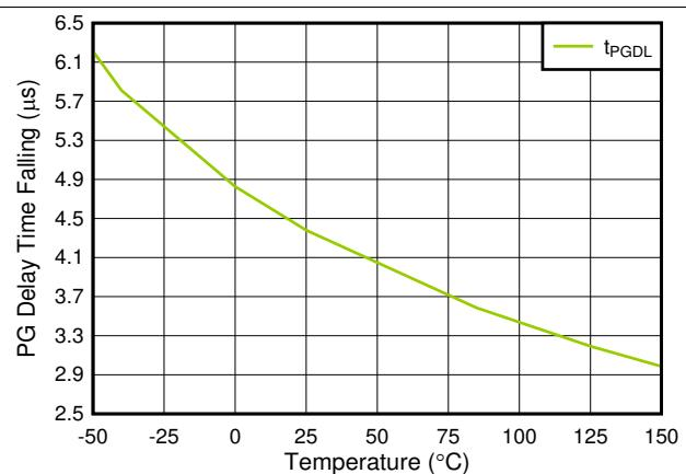
图 20. t<sub>PGDL</sub> vs Temperature
