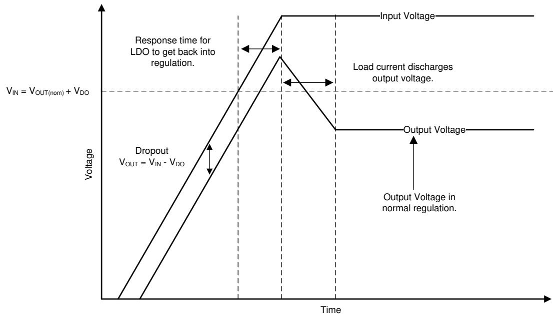
図 47. Startup Into Dropout
