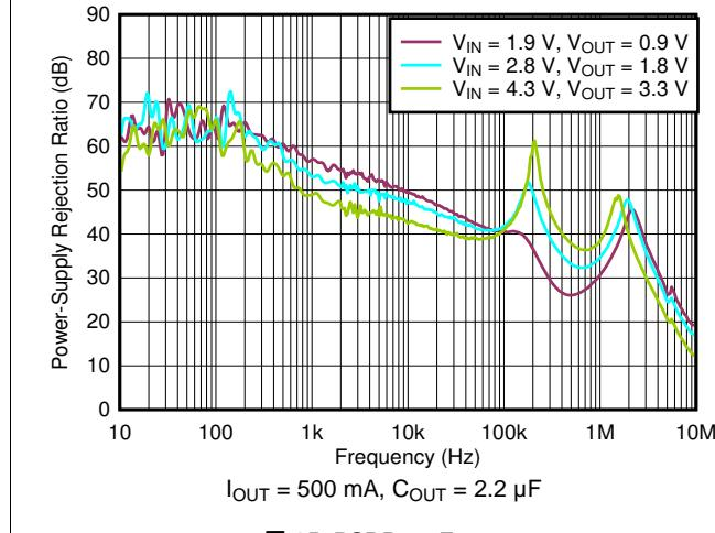
図 35. PSRR vs Frequency
