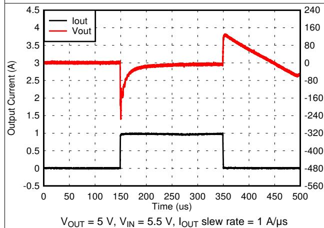
图 27. 1-mA to 1-A Load Transient (5 V)
