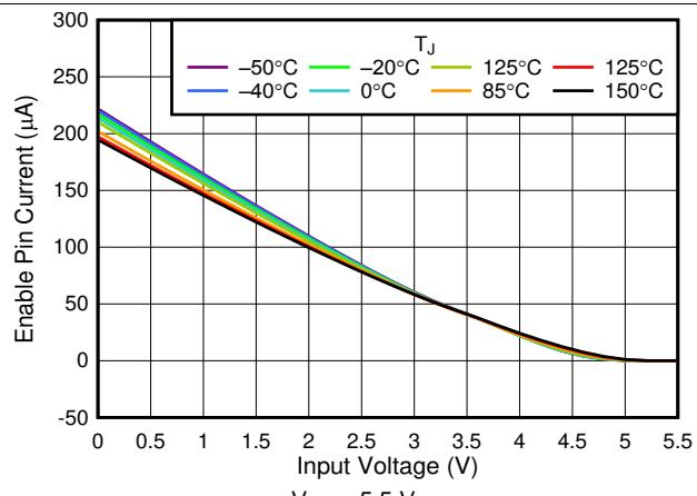
图 22. I<sub>EN</sub> vs V<sub>IN</sub>
