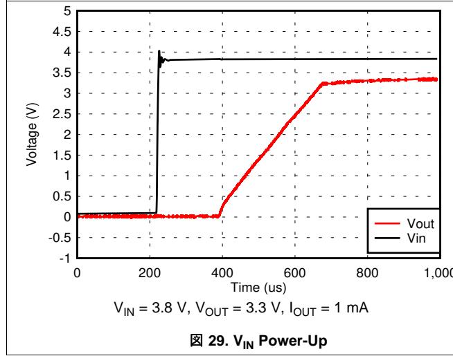
图 29.  $V_{IN}$  Power-Up
