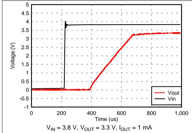
Figure 29.  $V_{IN}$  Power-Up
