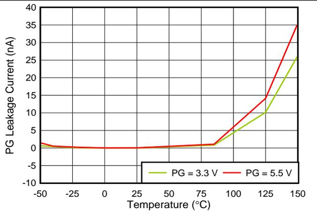
图 16.  $I_{ikg(PG)}$  vs Temperature and PG Pin Voltage
