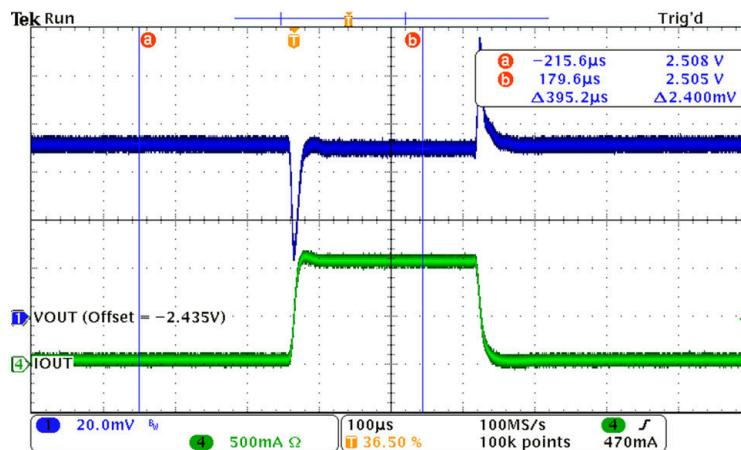
図 7-2. 1-A Load Transient Response
