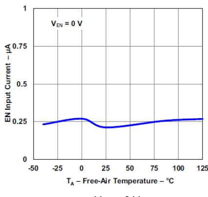
図 5-9. EN Input Current vs Temperature
