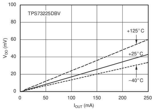
図 5-3. ドロップアウト電圧と出力電流との関係
