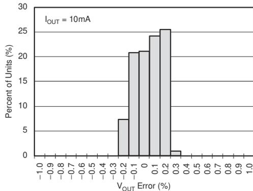
図 5-5. 出力電圧精度のヒストグラム
