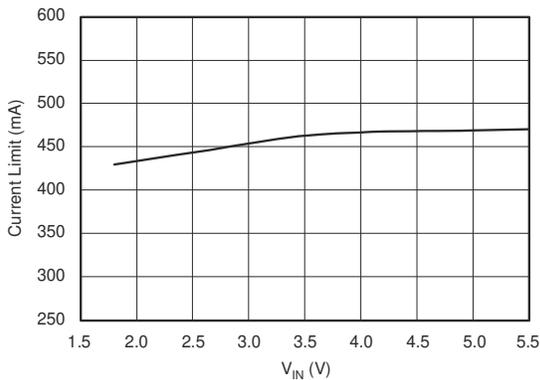
図 5-11. 電流制限と  $V_{IN}$  との関係
