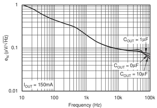
図 5-16. ノイズスペクトル密度  $C_{NR} = 0.01\mu\text{F}$
