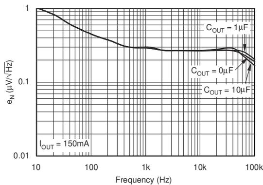
図 5-15. ノイズスペクトル密度  $C_{NR} = 0\mu\text{F}$
