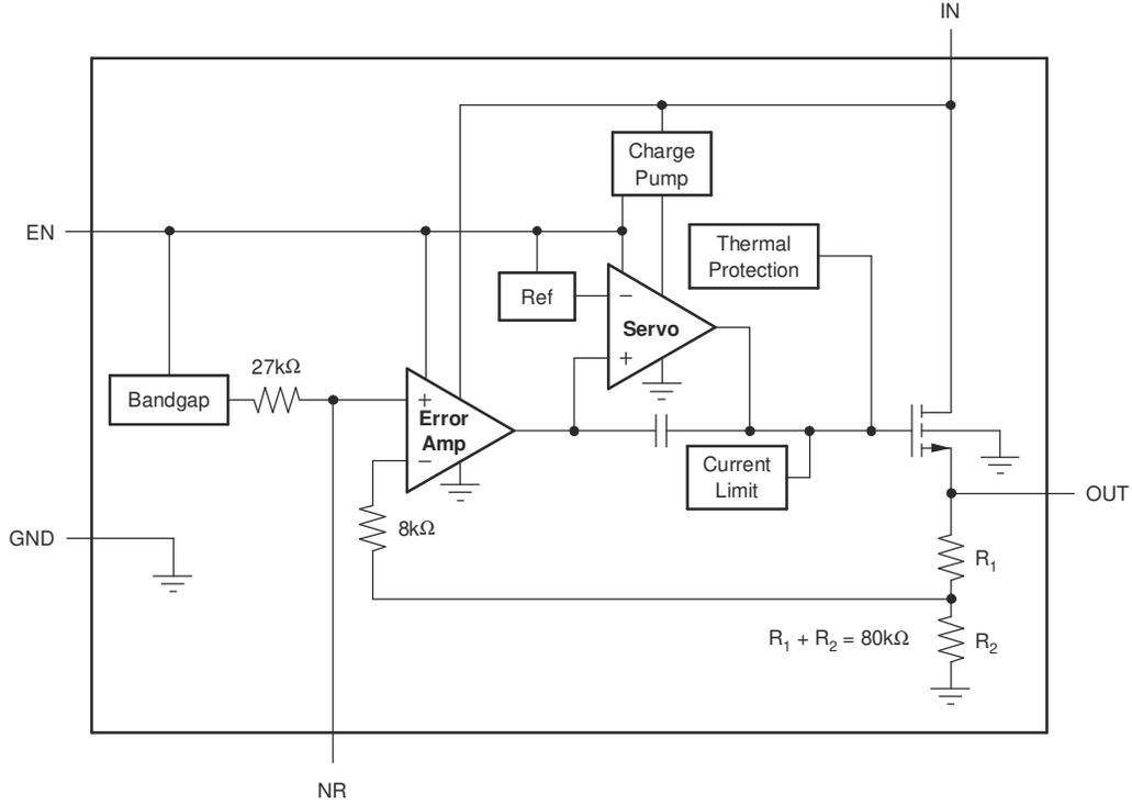
図 6-1. 固定電圧バージョン
