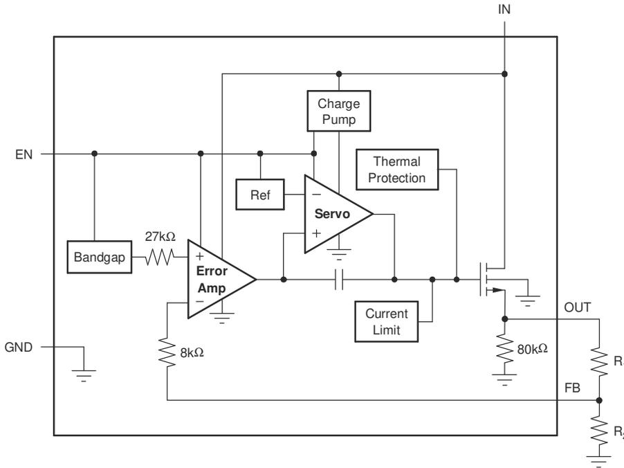
図 6-2. 可変電圧バージョン
