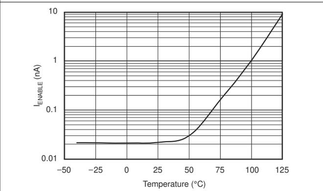
図 5-24.  $I_{ENABLE}$  vs 温度
