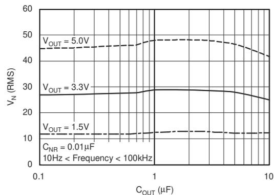
図 5-17. RMS ノイズ電圧と  $C_{OUT}$  との関係
