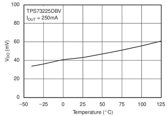
図 5-4. ドロップアウト電圧 vs 温度
