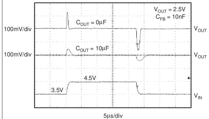
図 5-28. TPS73201 のライン過渡応答、可変バージョン
