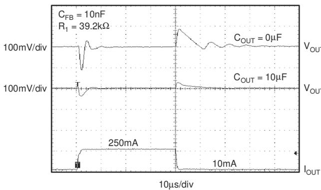
図 5-27. TPS73201 の負荷過渡応答、可変バージョン
