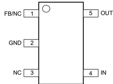
図 4-2. DCK Package, 5-Pin SC70 (Top View)
