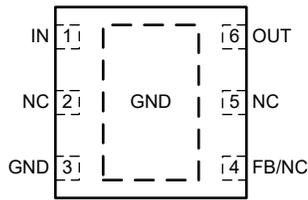
図 4-1. DRV Package, 6-Pin WSON (Top View)
