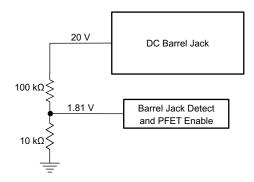
図 10-4. DC Barrel Jack Voltage Divider
