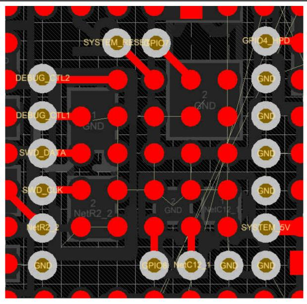
図 12-15. Void Via Placement
