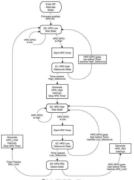
図 9-43. HPD TX Flow Diagram
