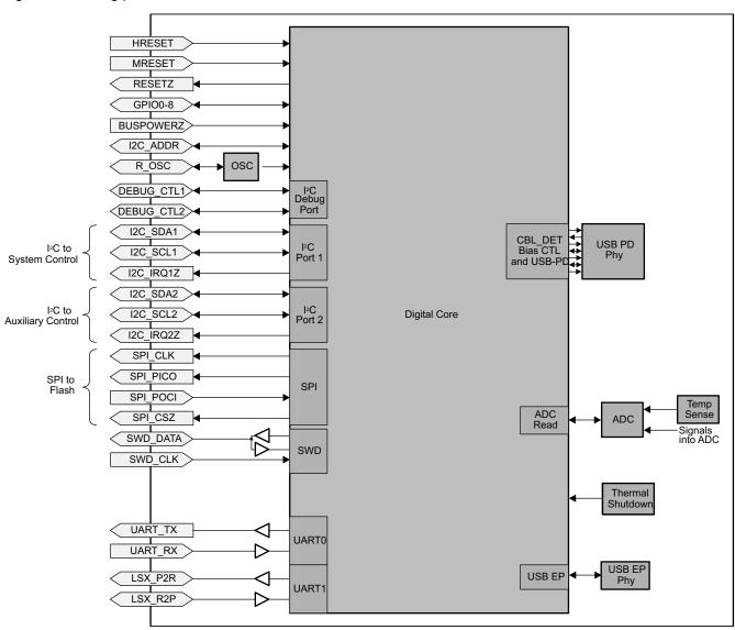
図 9-41. Digital Core Block Diagram
