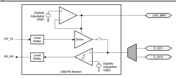
図 9-5. USB-PD BMC TX/Rx Block Diagram
