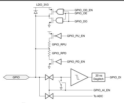
図 9-45. IOBUF\_GPIOLS (General GPIO) I/O
