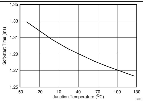
図 12. Soft-Start Time vs Junction Temperature
