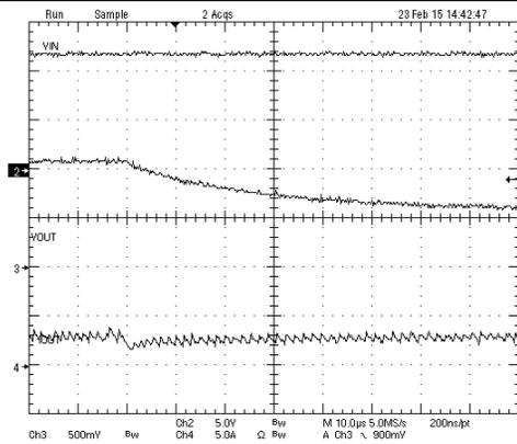
Figure 35. V<sub>OUT</sub> Step Down With V<sub>ID</sub>
