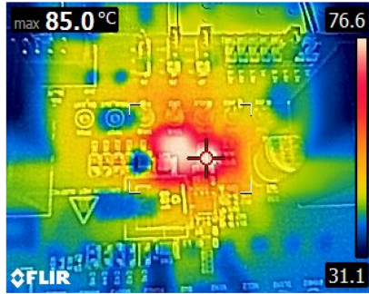
図 5-7. Thermal Image – 5V Output, TPS54KB20EVM, 6 Layers
