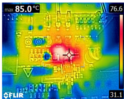
図 5-7. Thermal Image – 5V Output, TPS54KB20EVM, 6 Layers
