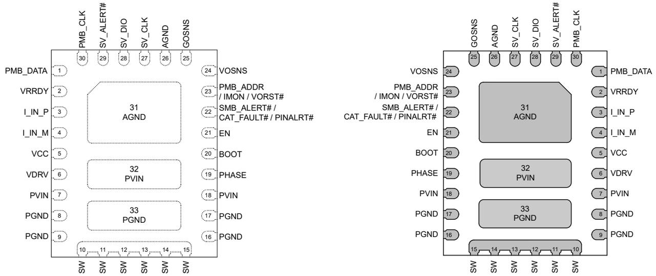
図 4-1. 33 ピン VBD、WQFN-FCRLF パッケージ (上面) 図 4-2. 33 ピン VBD、WQFN-FCRLF パッケージ (底面)
