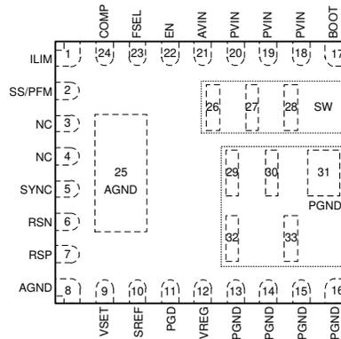
图 5-1. RJM Package 33-Pin VQFN Top View
