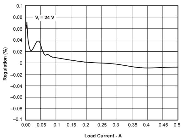
図 61. レギュレーション 対 負荷電流
