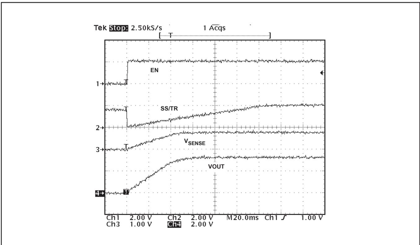
図 30. 起動時のSS/TRピンの動作
