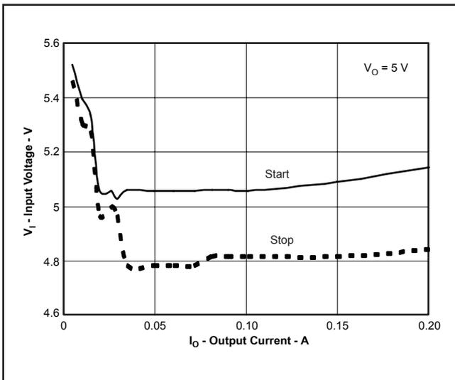
図 27. 5.0Vアプリケーションの開始/停止電圧
