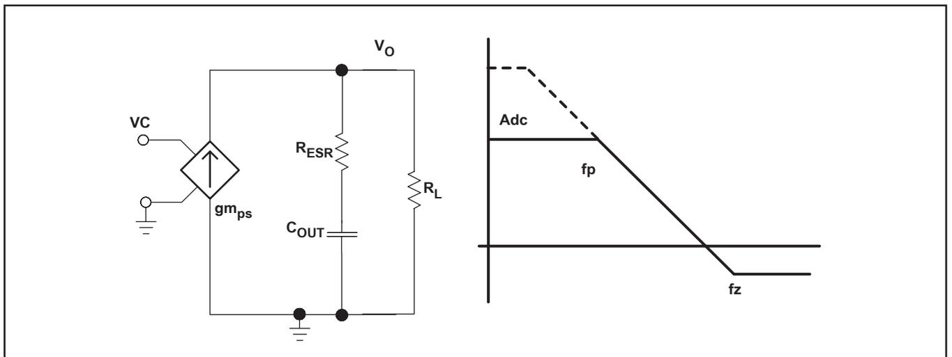
図 47. ピーク電流モード制御の単純な小信号モデルおよび周波数応答
