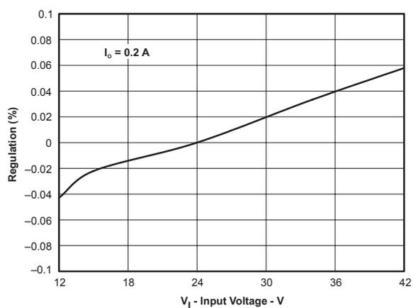
図 62. レギュレーション 対 入力電圧
