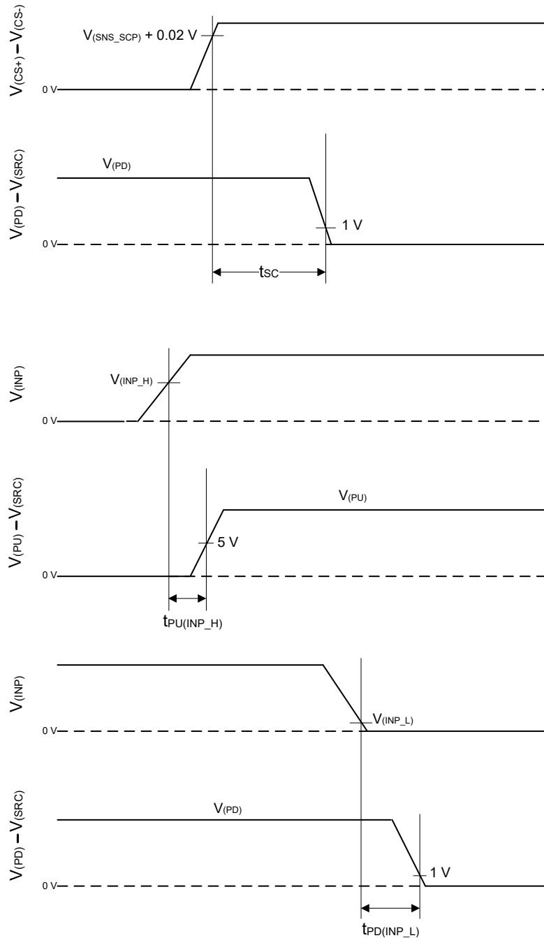
図 6-1. Timing Waveforms
