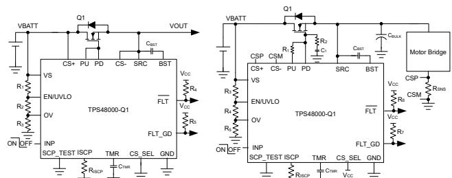
ハイサイド VDS センシングとローサイド電流センシングを使用する構成
