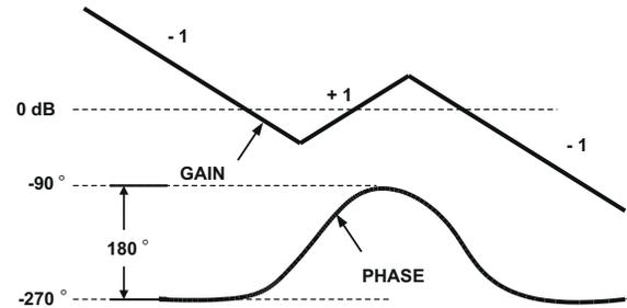
图 7-7. Type III Compensation Configuration
