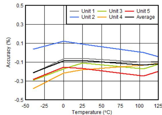
低電圧スレッショルド ( $V_{ITN}$ ) の精度と温度との関係
