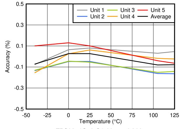
图 6-8. V<sub>ITN</sub> + V<sub>HYST</sub> Accuracy vs Temperature
