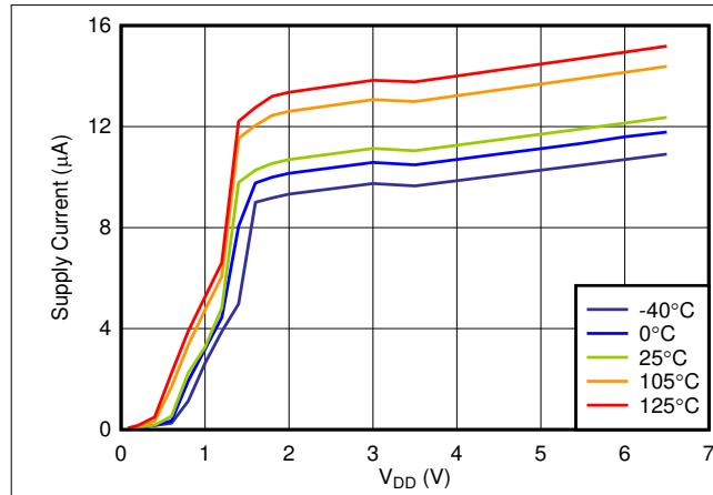
图 6-3. Supply Current vs V<sub>DD</sub>
