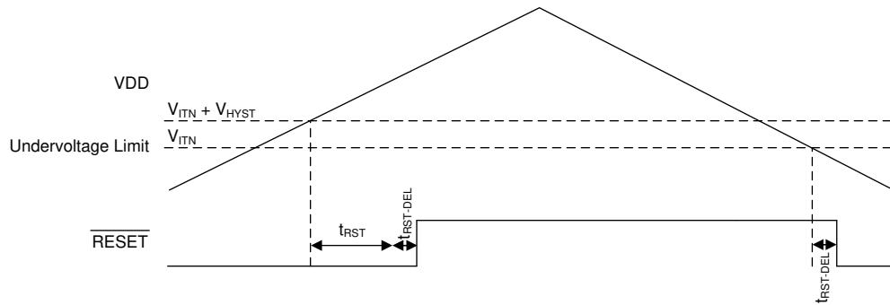
图 7-1. Undervoltage Detection
