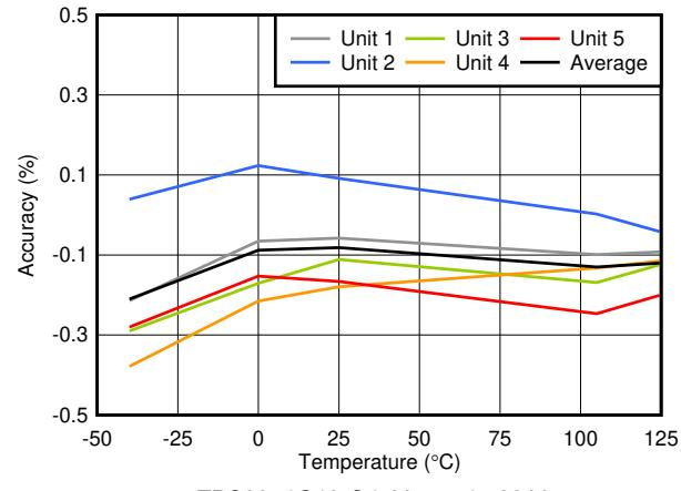
图 6-7. V<sub>ITN</sub> Accuracy vs Temperature
