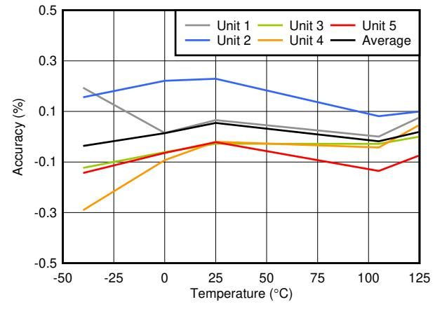
图 6-6. V<sub>ITN</sub> + V<sub>HYST</sub> Accuracy vs Temperature
