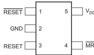
図 5-3. TPS3825-xx-Q1 : DBV パッケージ 5 ピン SOT-23 上面図
