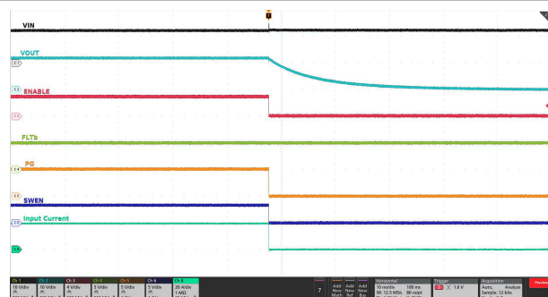
図 6-21. EN/UVLO ピンを使用した電源オンおよびオフシーケンシング
