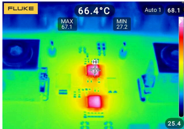
図 8-12. 室温での 110-A DC 電流による並列温度上昇 (エアフローなし) の 2 つのデバイス
