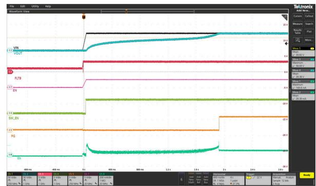
IN 電源は EN、C<sub>OUT</sub> = 500μF、C<sub>dVdt</sub> = 68nF、R<sub>OUT</sub> = 820Ω DVDT スケーリング 100% で 54V に上昇
