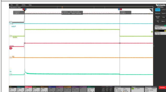
OUT は GND へ短絡。54V で安定している電源では、EN ピンを low から high に切り替え。
