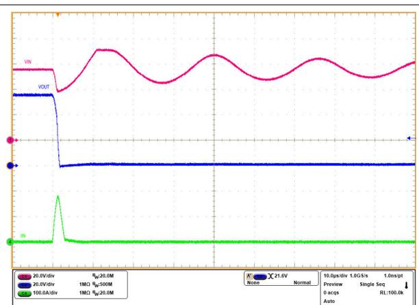
図 8-11. 出力ホット短絡応答
