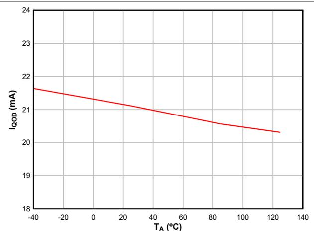
図 6-18. 温度範囲にわたる QOD シンク電流
