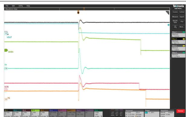
デバイスは定常状態、OUT を GND に短絡。Vin = 51V。C<sub>OUT</sub> = 3μF
