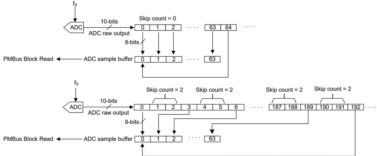
図 7-18. ADC サンプルバッファの例
