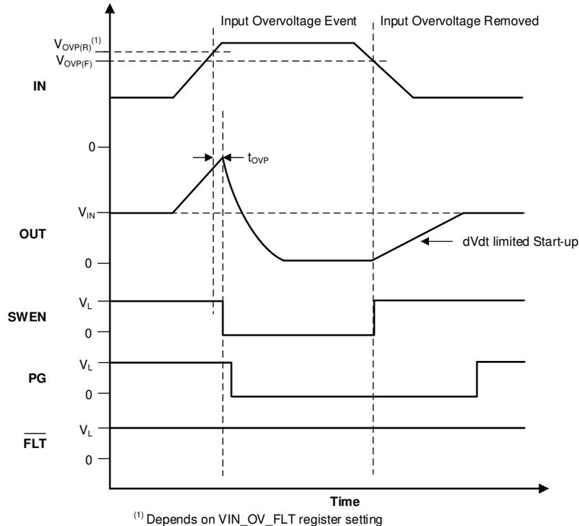
図 7-3. 入力過電圧保護応答
