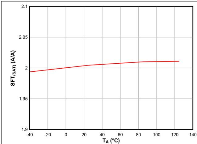
図 6-13. 温度範囲にわたる起動時のスケラブルな高速トリップスレッシュホルド比
