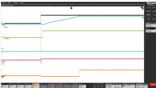
EN を high に保持し、IN 電源を 51V まで上昇。C<sub>OUT</sub> = 1mF、C<sub>dVdt</sub> = 68nF
