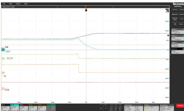
VIN 過電圧立ち上がりスレッショルドは 60.47V にプログラム、EN は high に保持、電源電圧は 54V から 80V へと上昇、ランプレートは 10V/ms に設定。C<sub>OUT</sub> = 1mF、C<sub>dVdt</sub> = 68nF
