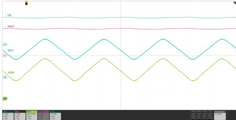
図 7-6. アナログ負荷電流モニタ応答
