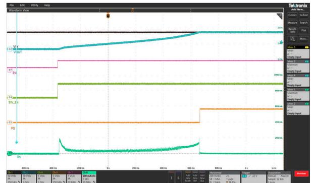
54V で安定している電源では、EN ピンを low から high に切り替え。C<sub>OUT</sub> = 1mF、C<sub>dVdt</sub> = 68nF
