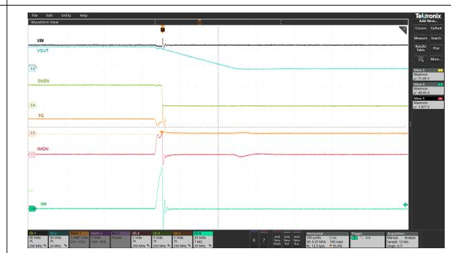
図 8-9. 出力ホット短絡応答
