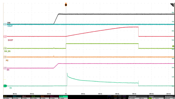
図 8-7. パワーアップ時の短絡 : V_{IN} = 54V 、EN/UVLO が 0V から 3V に昇圧
