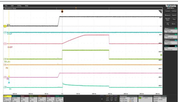
SWEN で出力を GND にハード短絡した状態で本デバイスをオンにします。デバイスはフォールドバックで電流を制限します。
