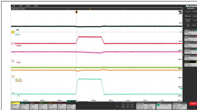
$I_{OCP} = 22A$ ,  $t_{TIMER} = 1.4ms$ ,  $I_{OUT}$  は、 $I_{OCP}$  スレッシュホールドを超えてサーキットブレイカ応答をトリガすることなく発生します
