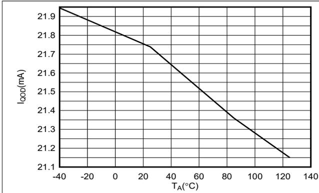
図 6-7. QOD の放電電流と温度との関係
