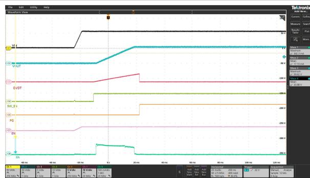
$C_{OUT} = 144\mu\text{F}$ 、 $C_{dvt} = 22\text{nF}$
