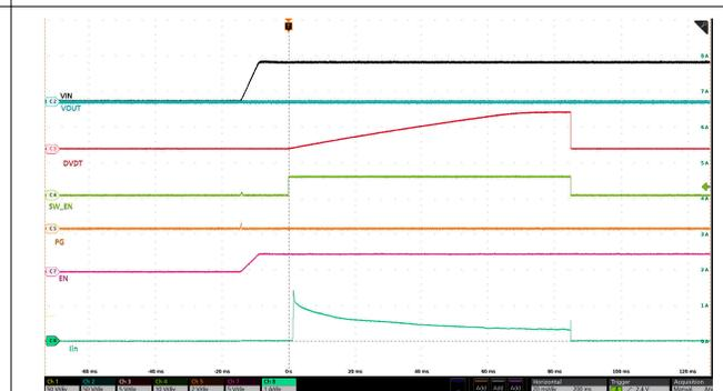
図 8-7. パワーアップ時の短絡： $V_{IN} = 54V$ 、EN/UVLO が 0V から 3V に昇圧
