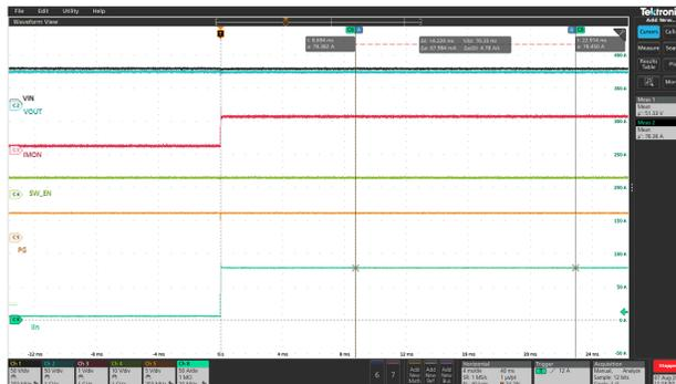
図 7-6. アナログ負荷電流モニタ応答
