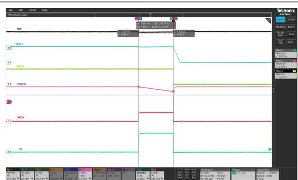
$I_{OCP} = 50A$ ,  $t_{TIMER} = 1.4ms$ ,  $I_{OUT}$  はサーキットブレイカ応答をトリガするため、 $I_{OCP}$  スレッシュホールドを維持し続けます
