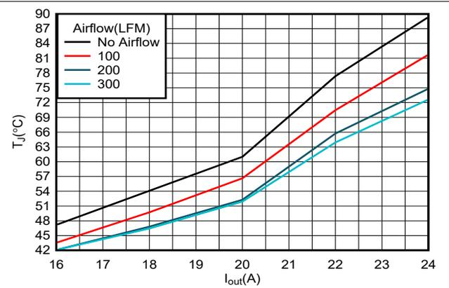
図 6-12. 接合部温度と負荷電流との関係 (T<sub>A</sub> = 25°C、エアフローあり/なし)
