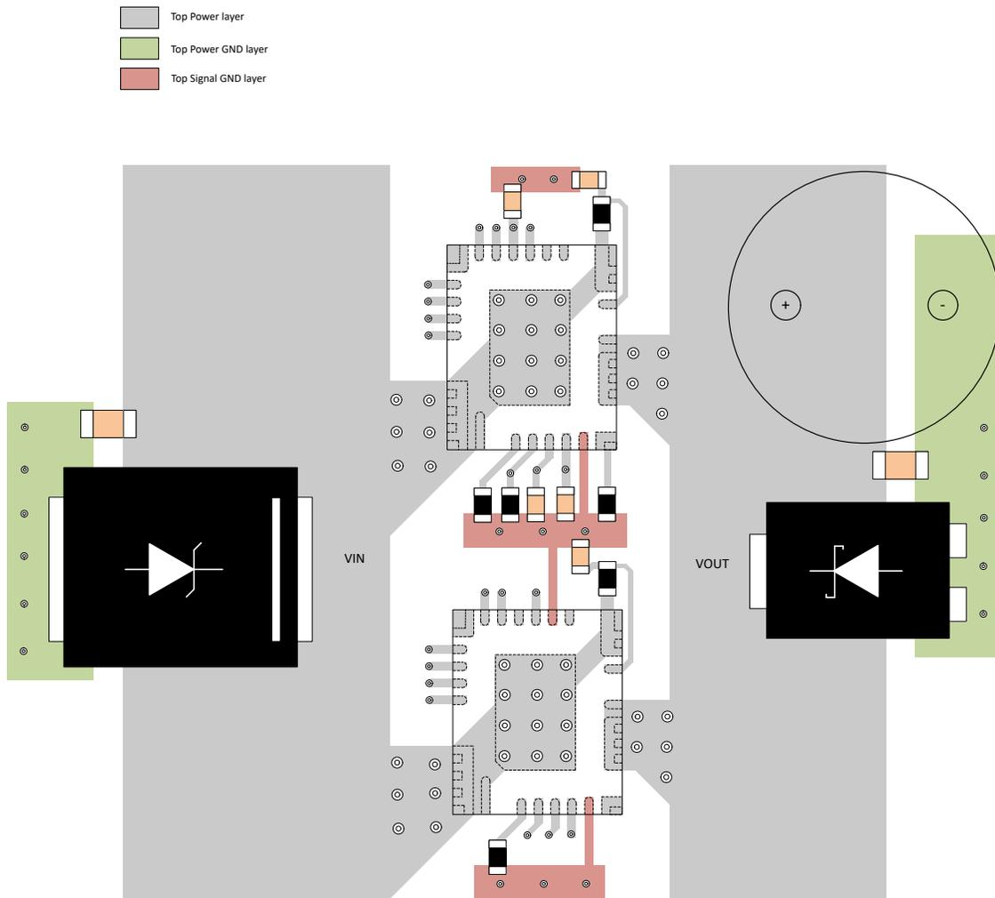
図 8-11. TPS1685x 2 並列デバイスのレイアウト例
