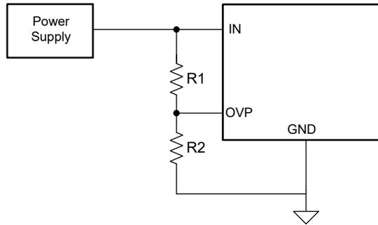
図 7-2. 調整可能な過電圧保護機能
