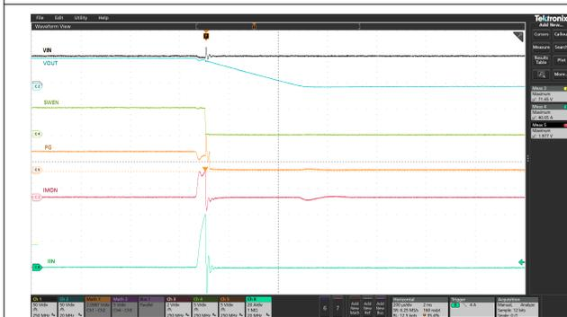
$I_{OCP} = 22A$ 、定常状態の GND への出力ハード短絡。  $I_{OUT}$  が  $2 \times I_{OCP}$  を上回ると、高速トリップ応答がトリガされます
