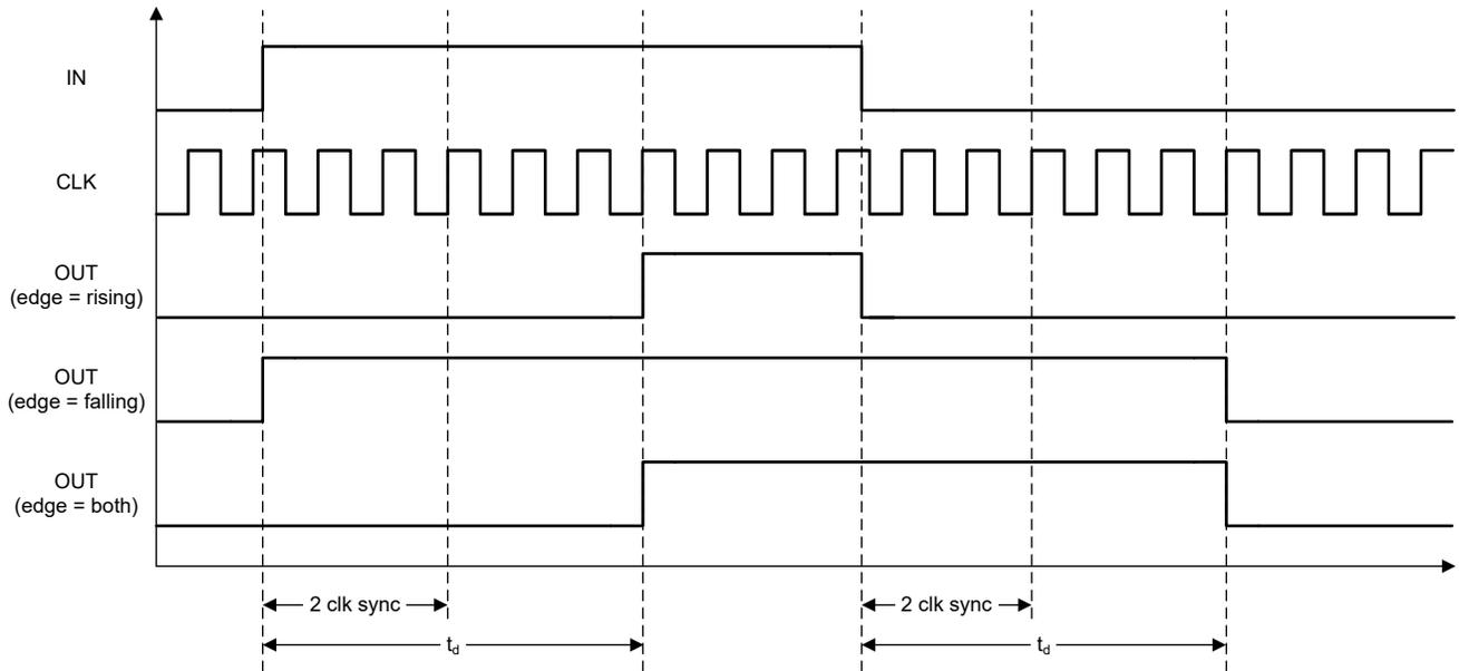
図 7-12. 遅延出力タイミングの例 (DATA = 3)
