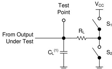
(1) C<sub>L</sub> にはプローブとテスト装置の容量が含まれます。
