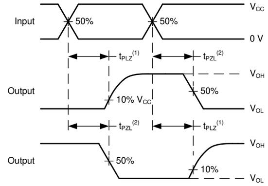
(1)  $t_{PLZ}$  と  $t_{PZL}$  の大きい方が  $t_{pd}$  に相当します。
