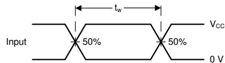
図 6-4. 電圧波形、パルス幅
