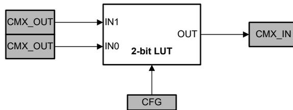
図 7-2. 2 ビット LUT のブロック図
