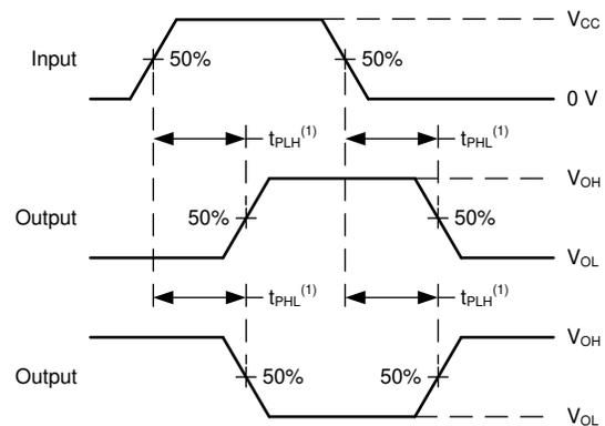
(1) t<sub>PLH</sub> と t<sub>PHL</sub> の大きい方が t<sub>pd</sub> に相当します。
