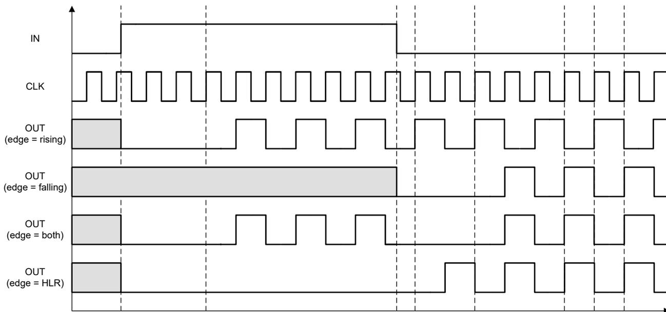
図 7-14. カウンタ出力タイミングの例 (DATA = 1)
