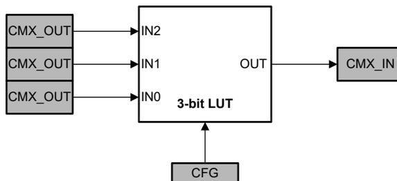
図 7-3. 3 ビット LUT のブロック図
