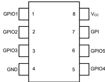
図 4-1. DRL パッケージ、8 ピン SOT-5X3 (上面図)
