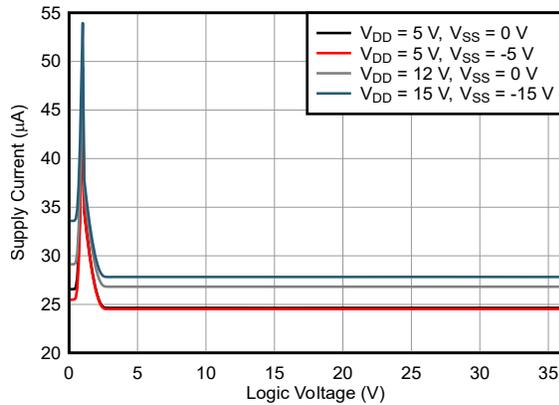
図 6-13. 電源電流とロジック電圧との関係
