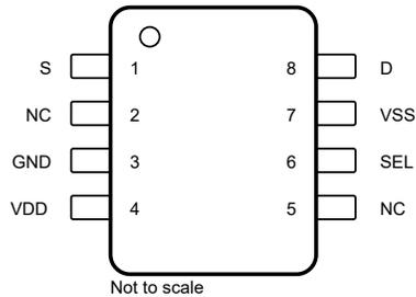
図 5-1. DGK パッケージ、8 ピン VSSOP (上面図)
