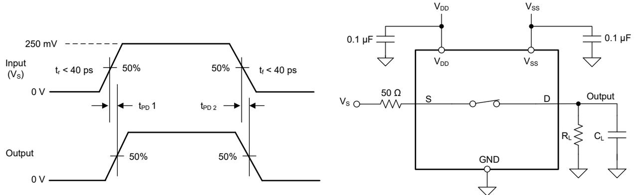
図 7-6. 伝搬遅延測定時の構成
