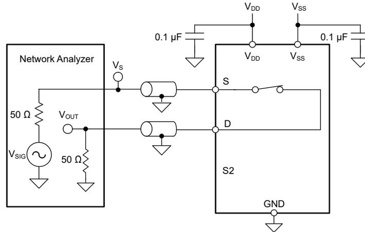
図 7-9. 帯域幅測定時の設定
