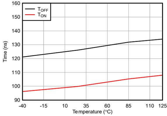
図 6-19.  $T_{ON}$  および  $T_{OFF}$  と温度との関係
