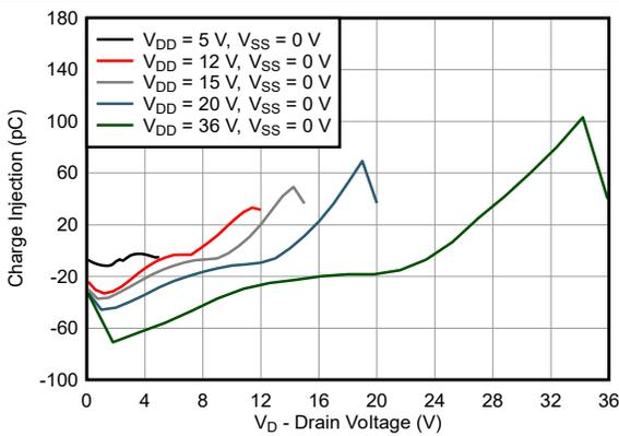
図 6-17. 電荷注入とドレイン電圧との関係 – 単一電源
