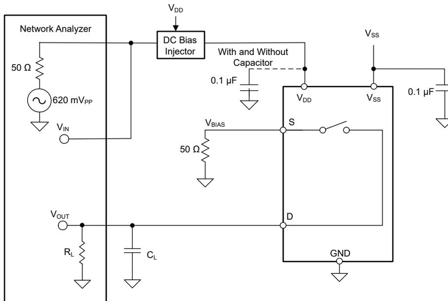
図 7-11. AC PSRR 測定時の構成
