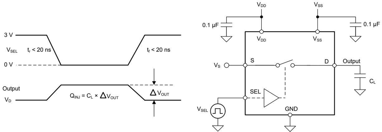
図 7-7. 電荷注入測定時の設定
