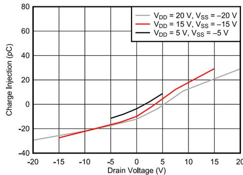
図 9-2. 電荷注入とソース電圧との関係
