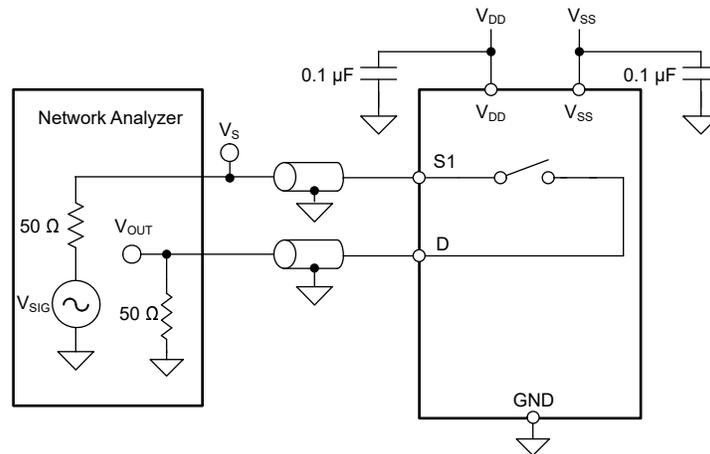
図 7-8. オフ絶縁測定時の設定
