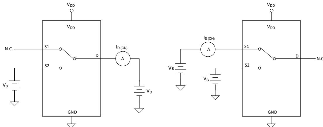
**図 6-3. On-Leakage Measurement Setup**
