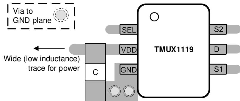
**図 8-4. TMUX1119 Layout Example**
