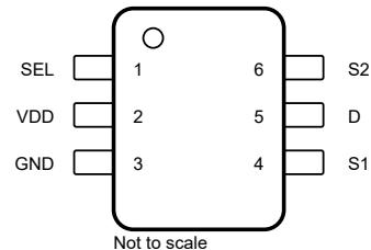
図 4-2. DBV Package, 6-Pin SOT-23 (Top View)
