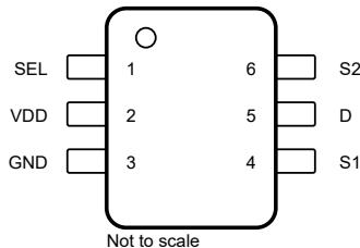
図 4-1. DCK Package, 6-Pin SC70 (Top View)
