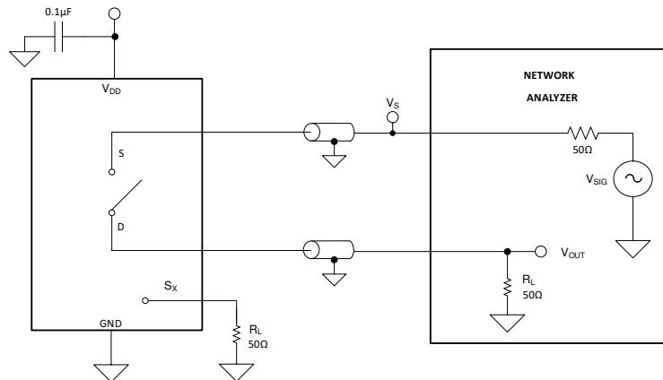
図 6-7. Off Isolation Measurement Setup
