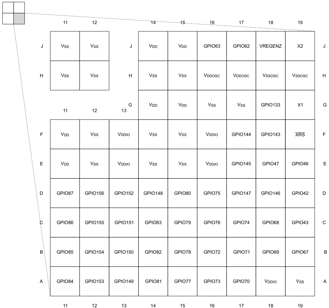
図 5-3. 337 ボール ZWT 新ファイン ピッチ ボール グリッド アレイ (底面図) – [象限 C]
