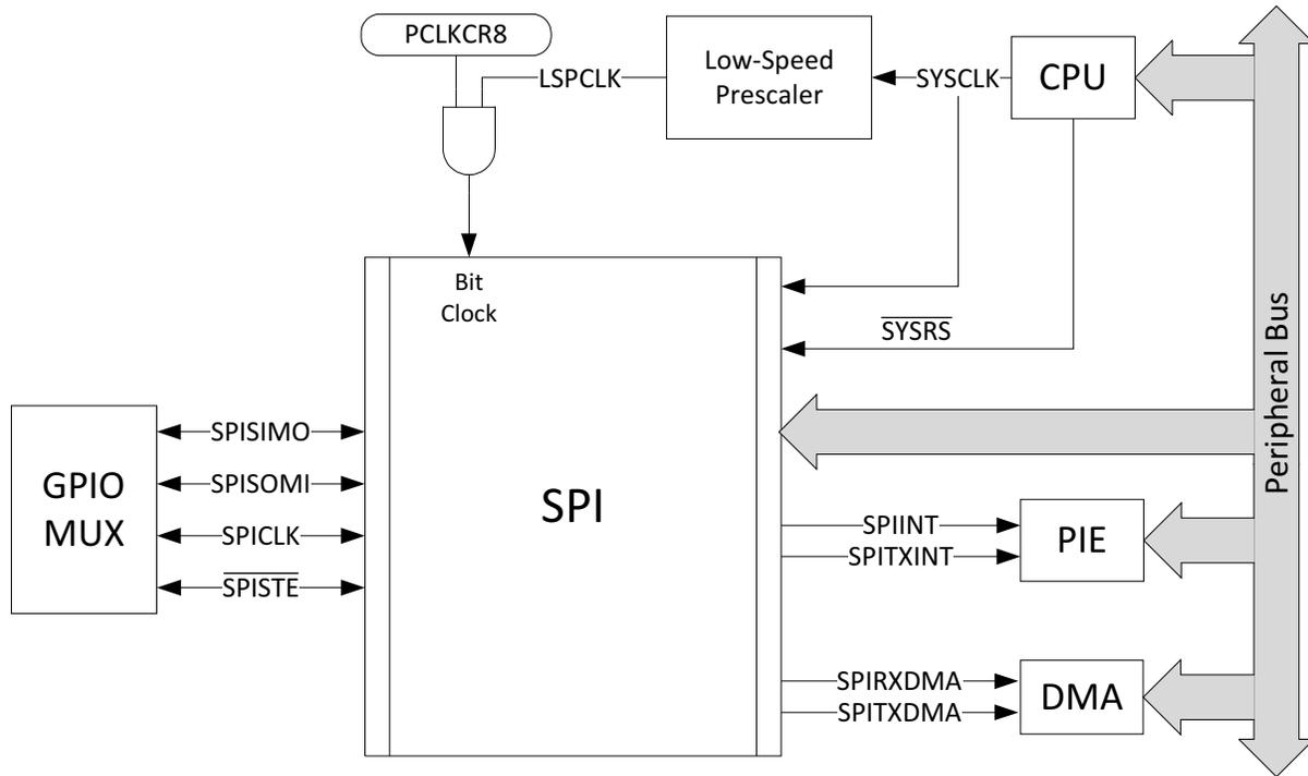
図 6-76. SPI CPU インターフェイス
