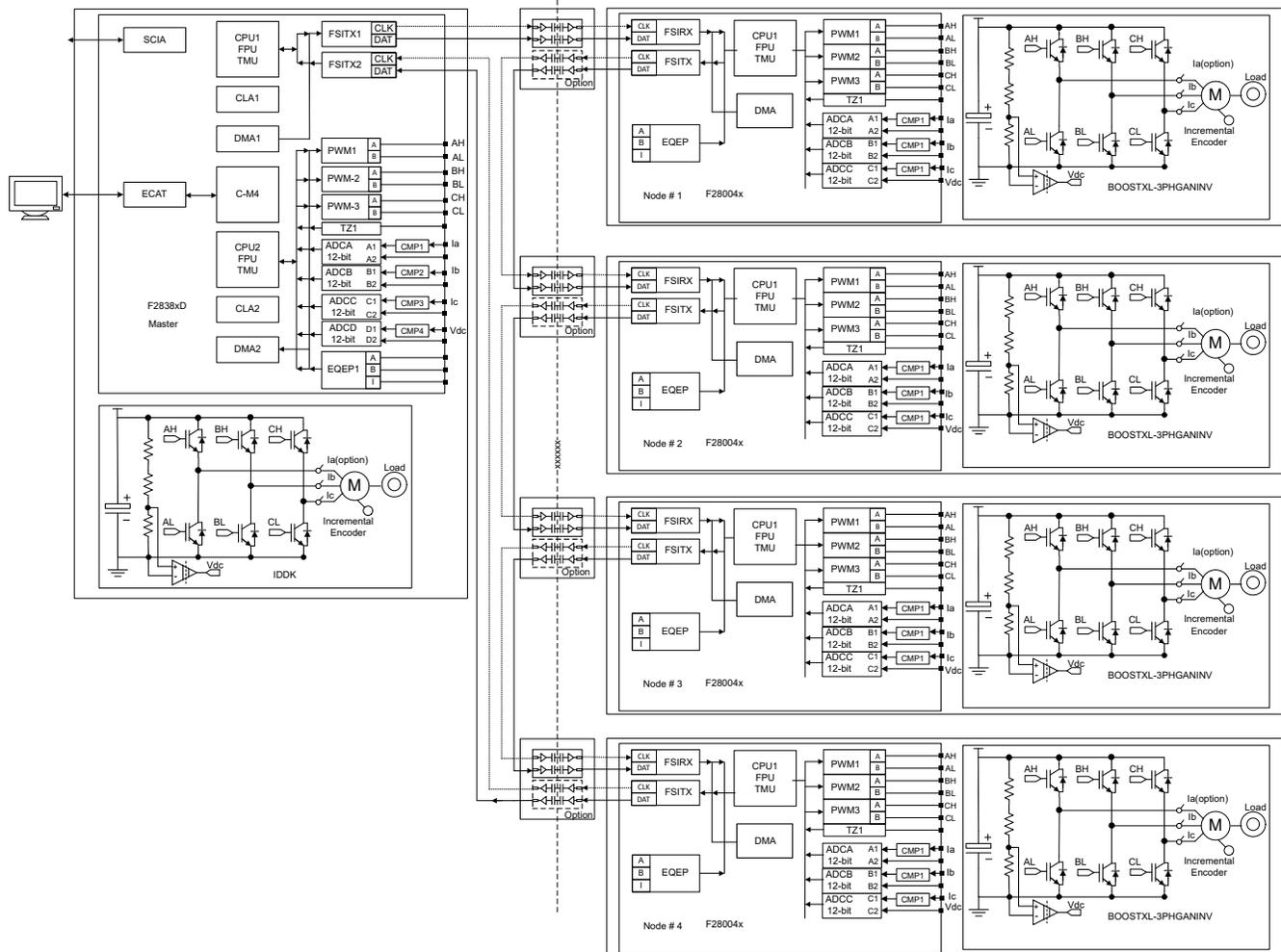
図 8-2. 分散型多軸サーボ・ドライブ
