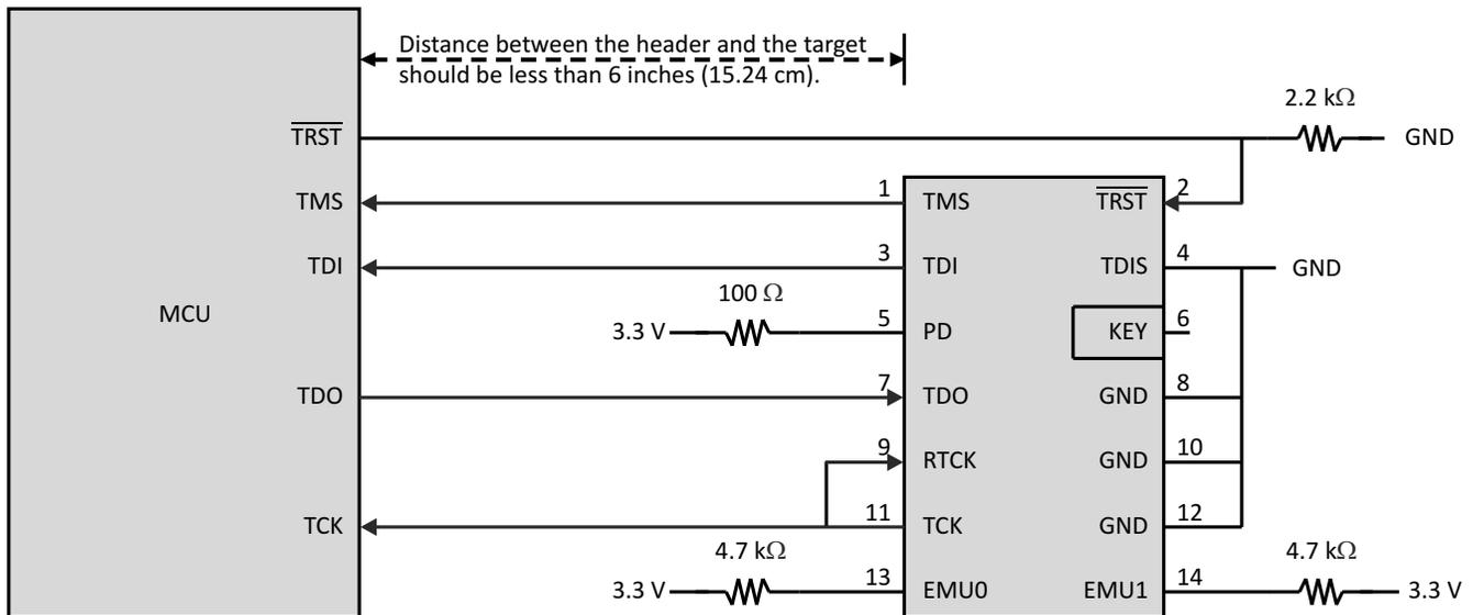
図 6-13. 14 ピン JTAG ヘッダーへの接続
