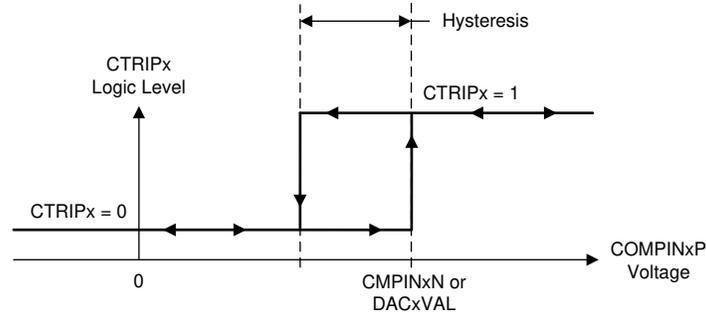
図 6-44. CMSS コンパレータのヒステリシス
