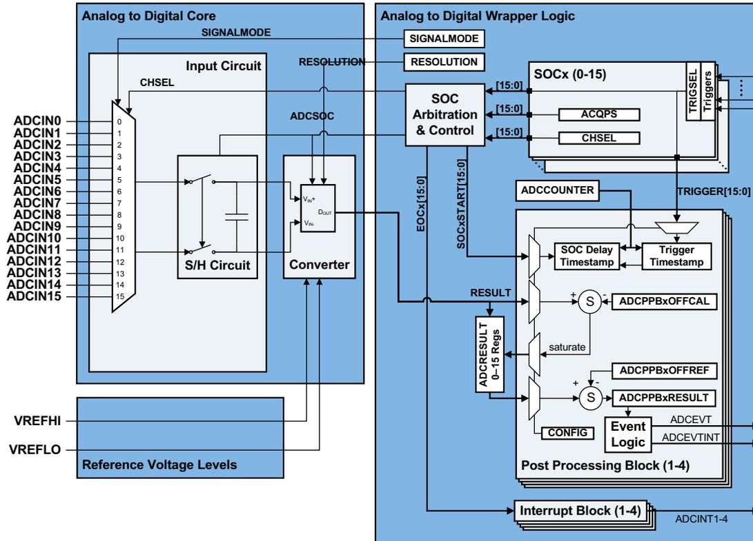
図 6-34. ADC モジュールのブロック図
