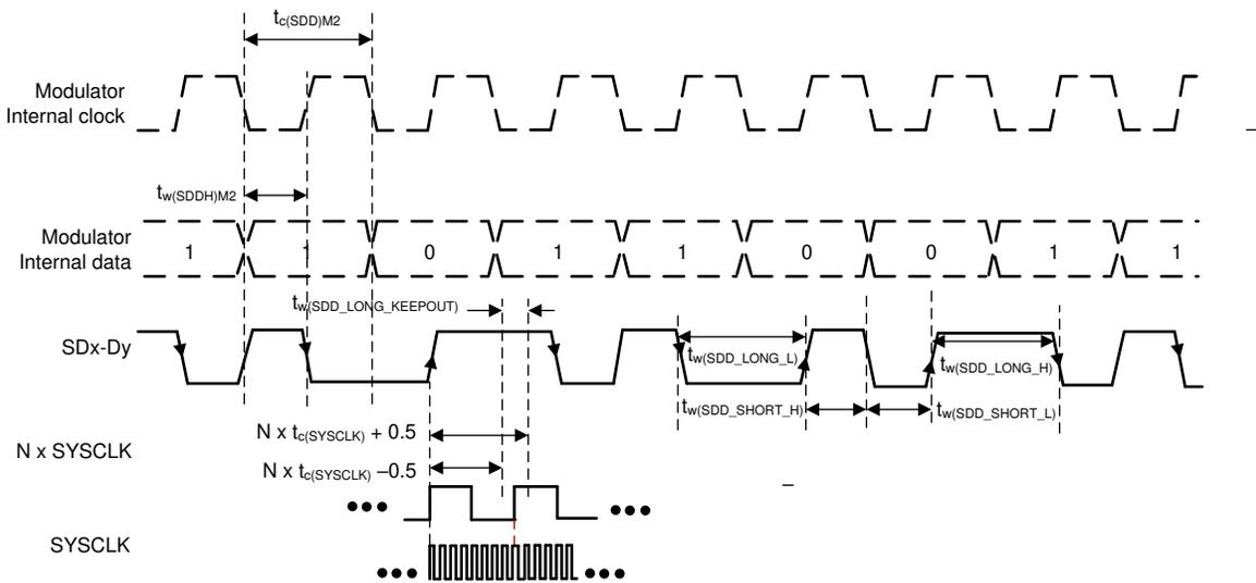
図 6-63. SDFM タイミング図 - モード 2
