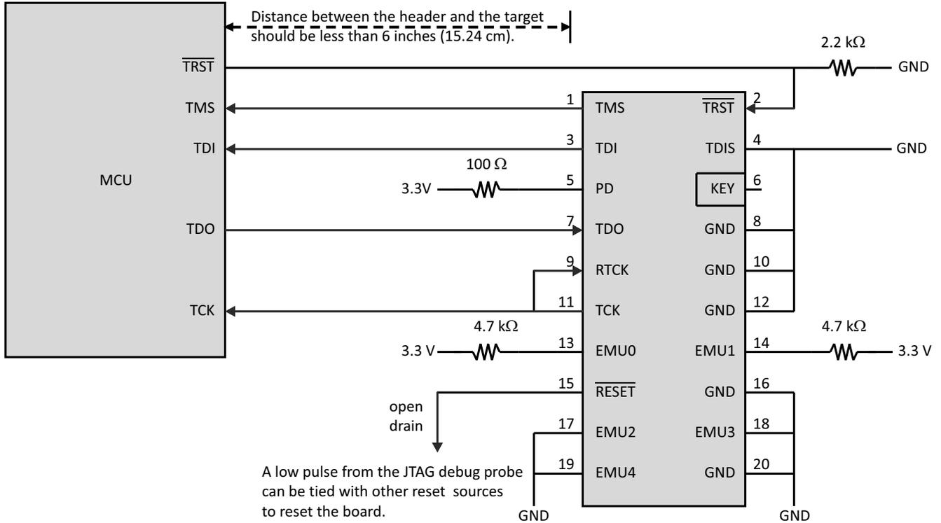
図 6-14. 20 ピン JTAG ヘッダーへの接続
