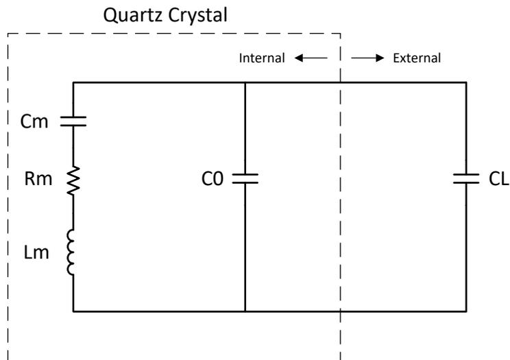
図 6-10. 水晶振動子の電氣的表現
