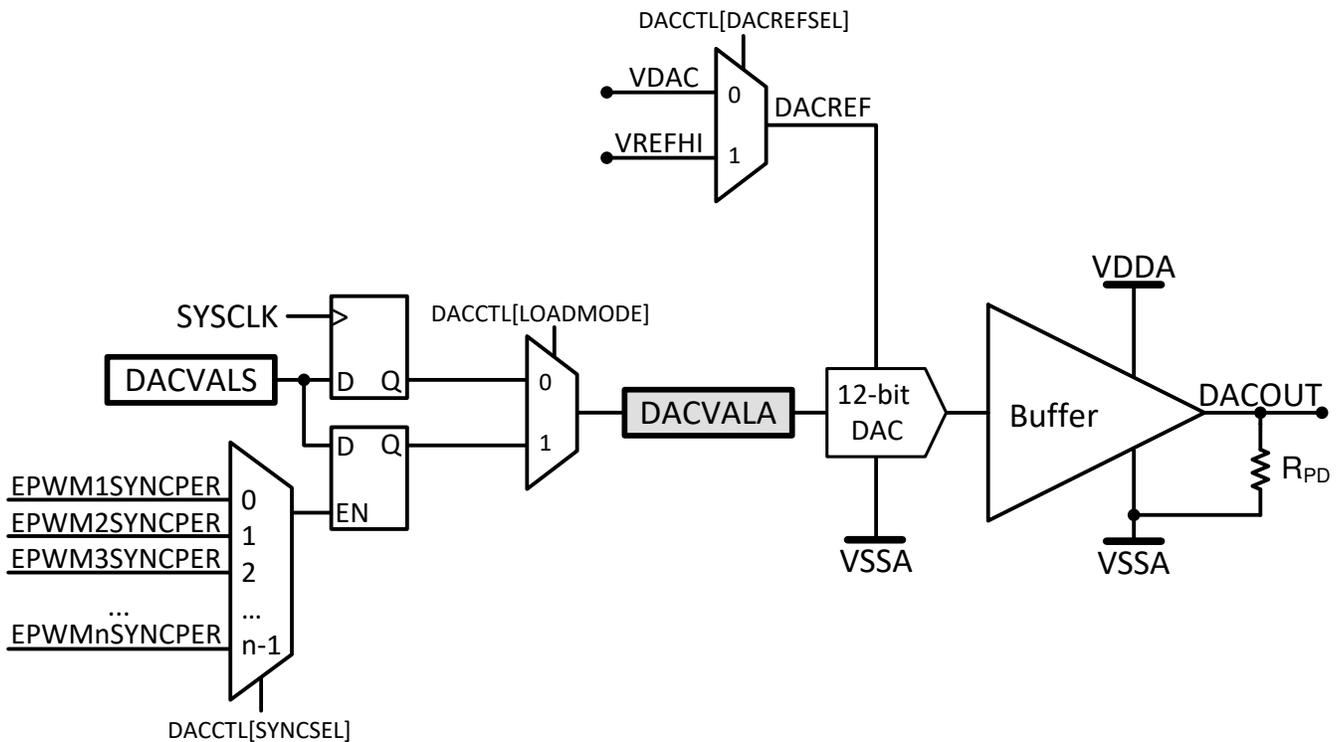
図 6-48. DAC モジュールのブロック図
