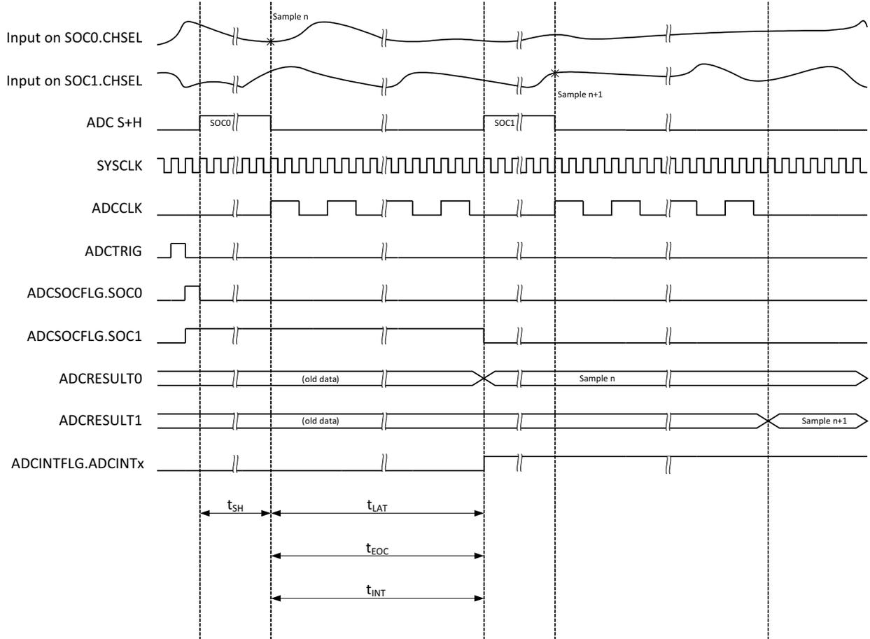
図 6-40. 16 ビットモードでの ADC タイミング
