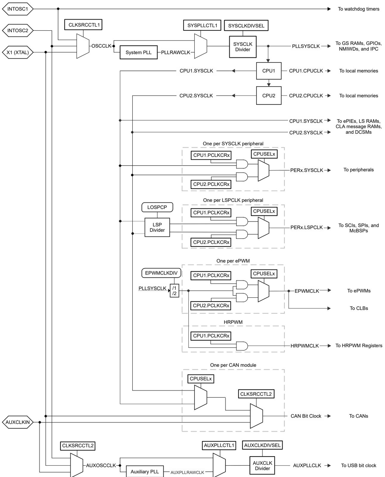
図 6-7. クロック供給システム
