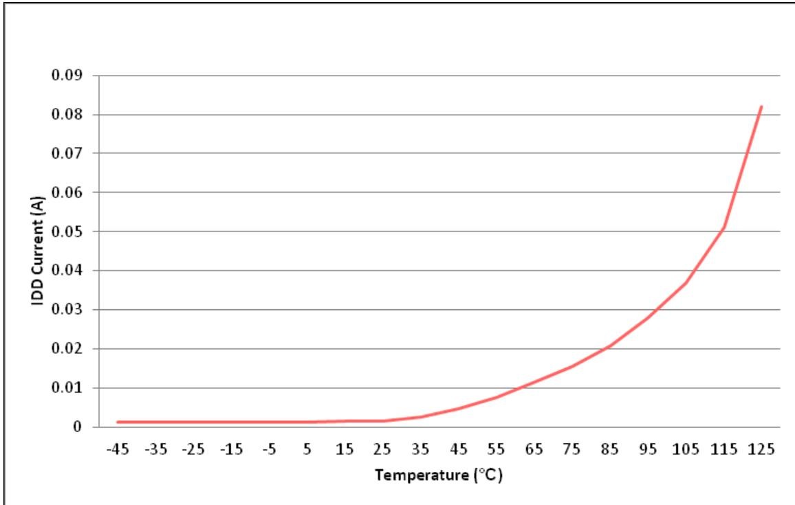
図 6-3.  $I_{DD}$  リーク電流と温度との関係
