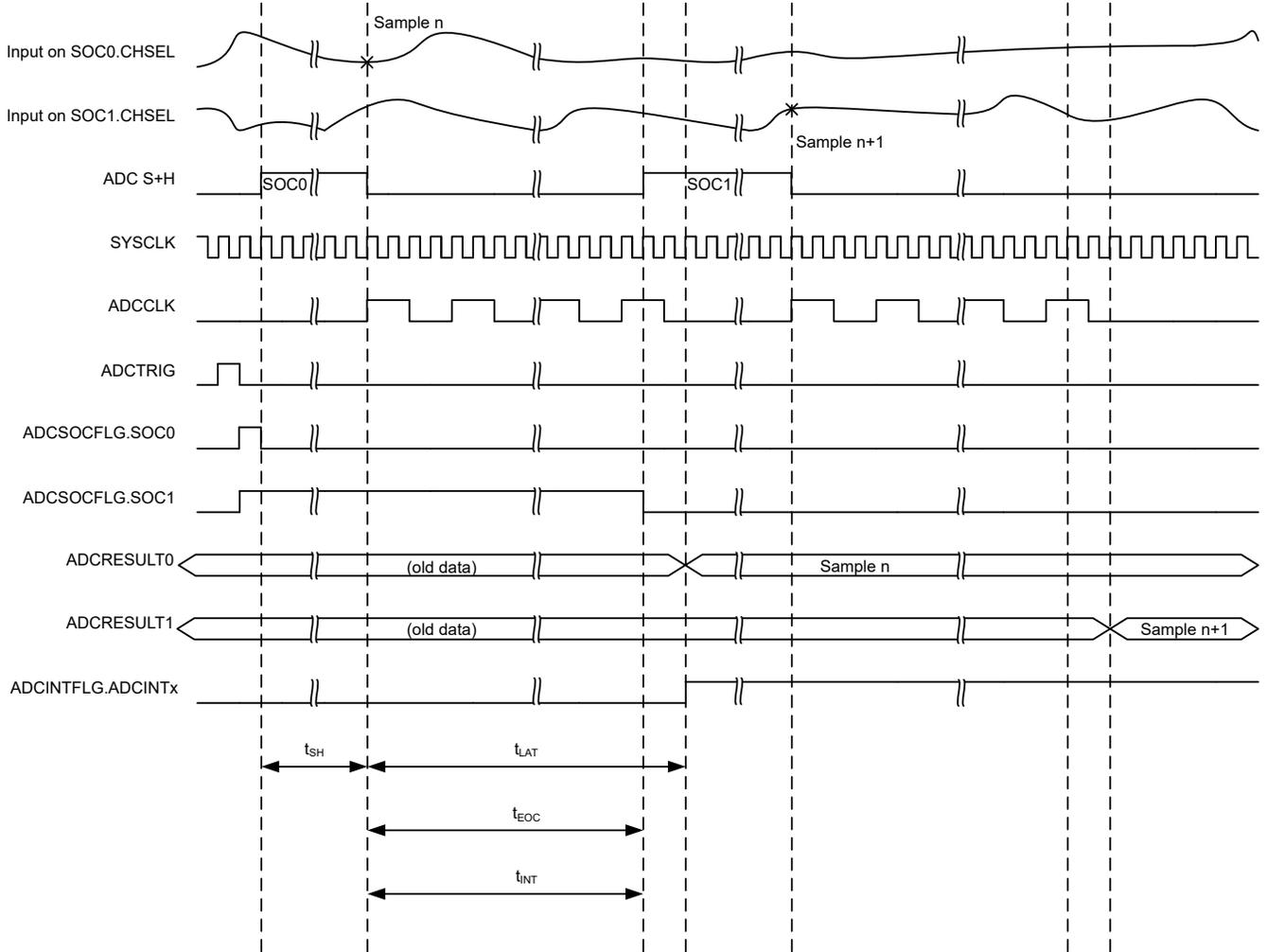
図 6-39. 12 ビットモードでの ADC タイミング
