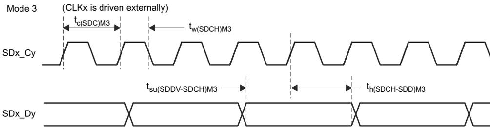
図 6-64. SDFM タイミング図 - モード 3
