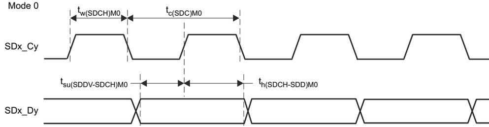
図 6-61. SDFM タイミング図 - モード 0
