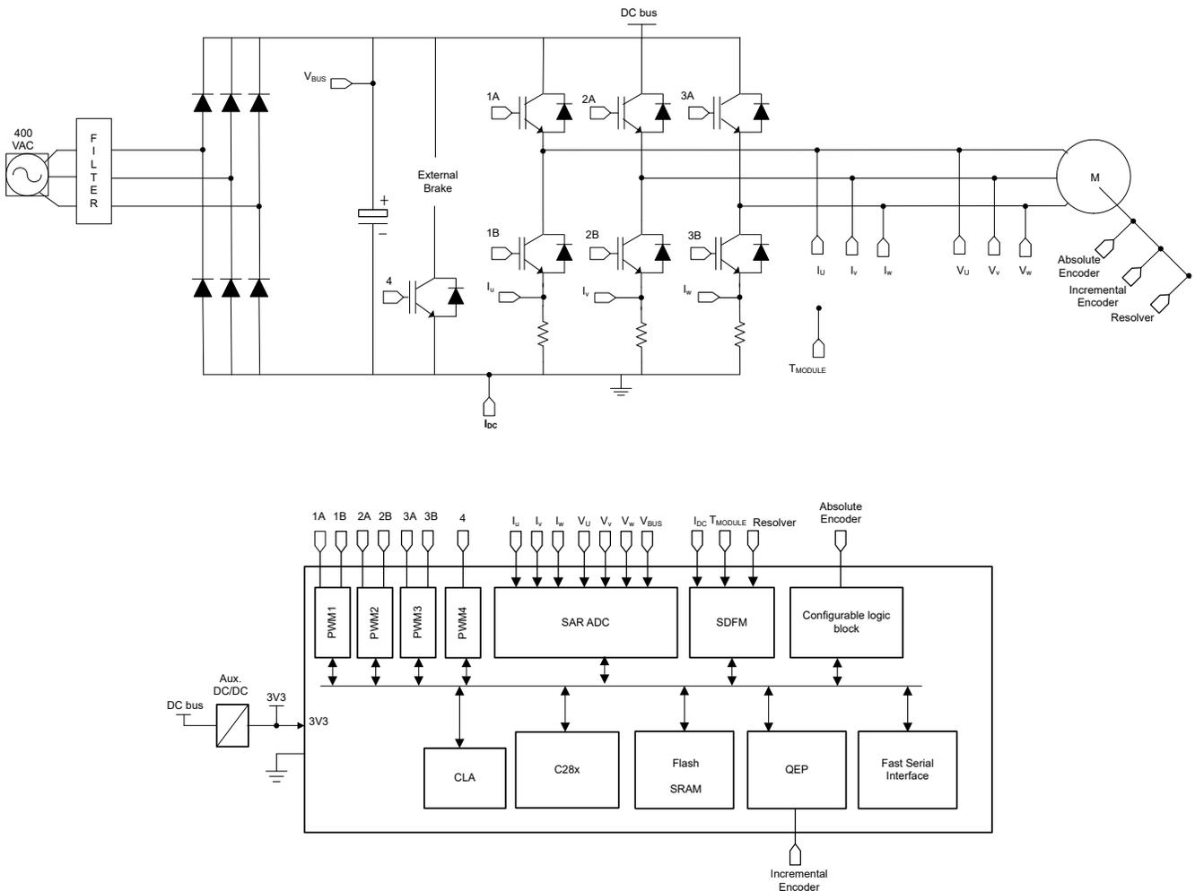
図 8-1. サーボ・ドライブ制御モジュール
