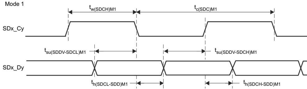
図 6-62. SDFM タイミング図 - モード 1
