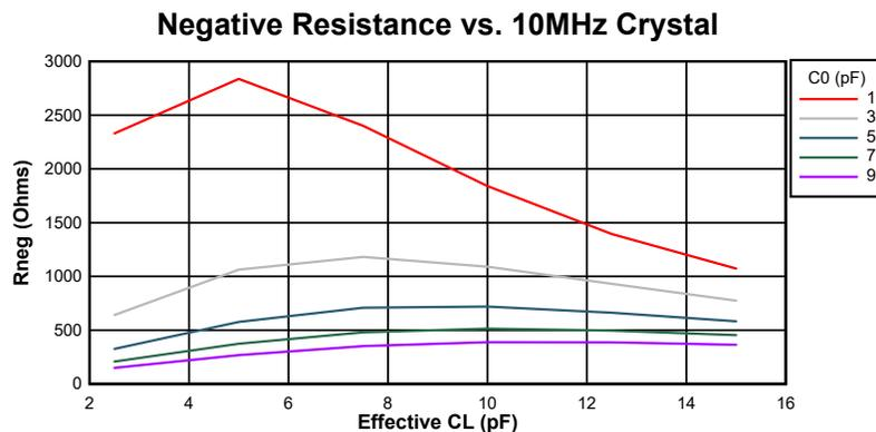
図 6-11. 10MHz 時の負性抵抗変動
