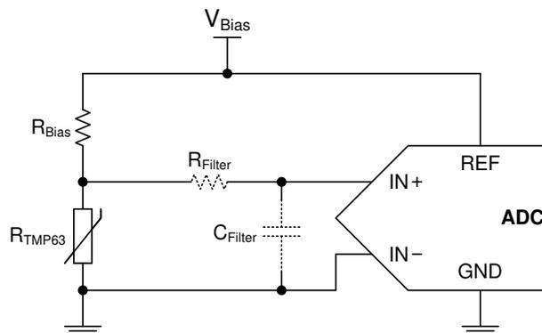
図 8-5. ADC を使用した分圧器
