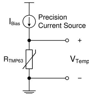
図 8-6. 電流源を使用したバイアス回路
