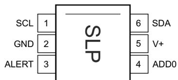
図 6-1. DRL パッケージ 6 ピン SOT563 上面図
