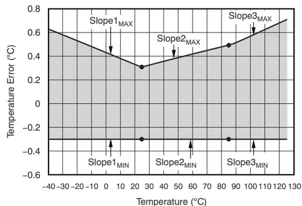
図 9-1. 温度に応じた精度と傾きの曲線
