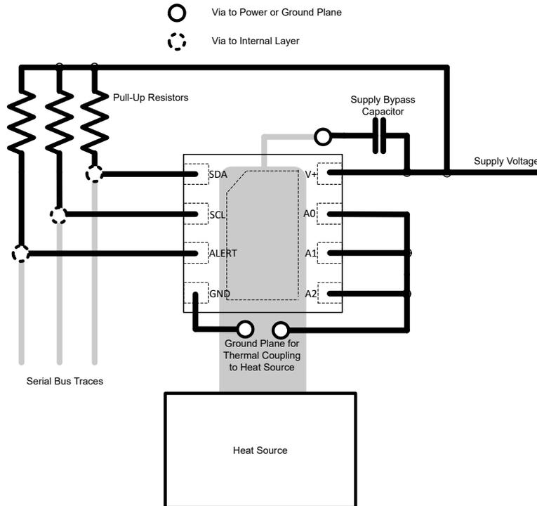
図 8-4. レイアウト例 (DSG パッケージ)
