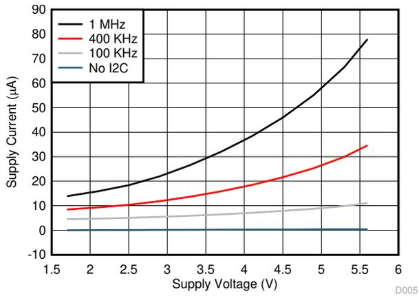
図 6-8. シャットダウン モードでの電源電流と I<sup>2</sup>C バス クロックおよび電源電圧との関係
