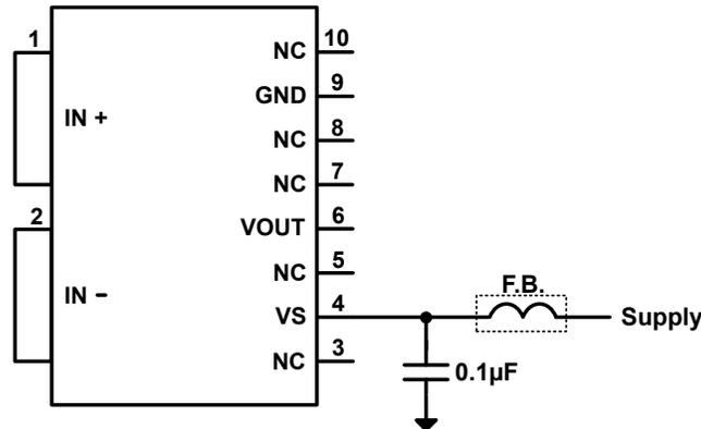
図 9-4. 電源ノイズのフィルタリング
