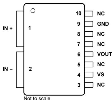
図 5-1. DVG パッケージ 10 ピン SOIC 上面図
