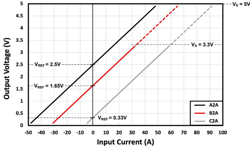
図 8-3. TMCS11xxx2A-Q1 の出力電圧と入力電流との関係
