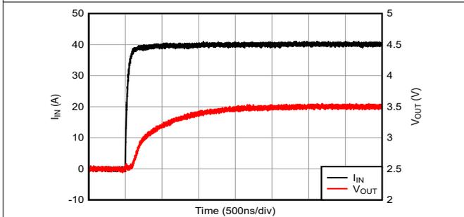
図 6-5. 電圧出力ステップ応答、立ち上がり
