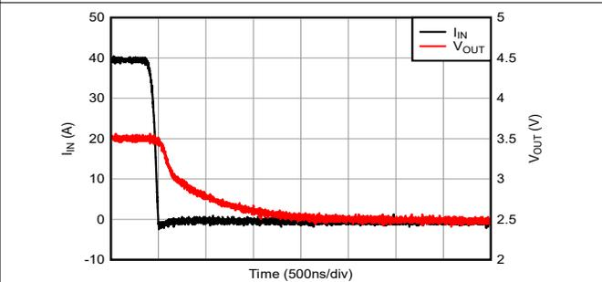
図 6-6. 電圧出力ステップ応答、立ち下がり
