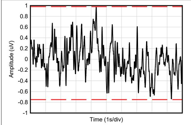
図 6-19. 0.1Hz~10Hz のノイズ
