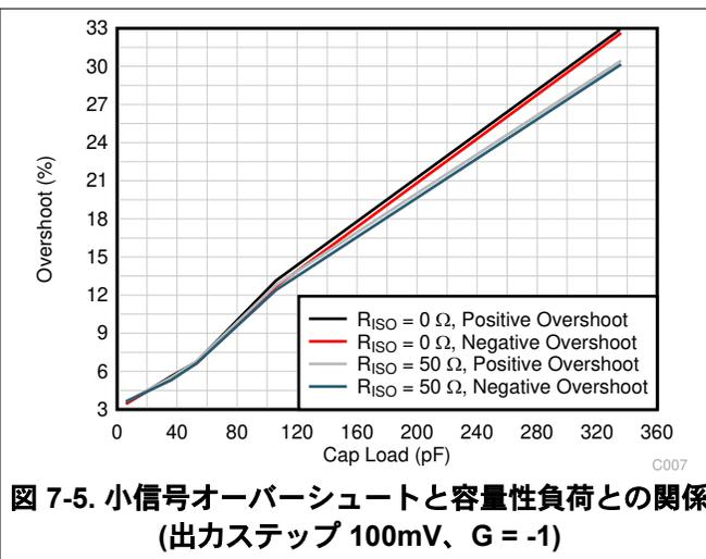
ユニティ・ゲイン構成で駆動能力を高めるため、図 7-6 に示すように、小さな (10Ω から 20Ω) 抵抗  $R_{ISO}$  を出力と直列に挿入し、容量性負荷の駆動能力を増やします。この抵抗は、リングングを大幅に低減し、純粋な容量性負荷に対して DC 性能を維持します。ただし、容量性負荷と抵抗性負荷が並列に接続されている場合、分圧回路が生まれるため、出力にゲイン誤差が生じ、出力スイングがわずかに減少します。発生する誤差は  $R_{ISO}/R_L$  の比に比例し、一般に低い出力レベルでは無視できます。TLV910x は容量性負荷の駆動能力が大きいため、リファレンス・バッファ、MOSFET ゲート・ドライバ、ケーブル・シールド・ドライブなどのアプリケーションに最適です。図 7-6 に示す回路は、絶縁抵抗  $R_{ISO}$  を使用してオペアンプの出力を安定させます。 $R_{ISO}$  は、システムの開ループ・ゲインを変更して位相マージンを増やします。
