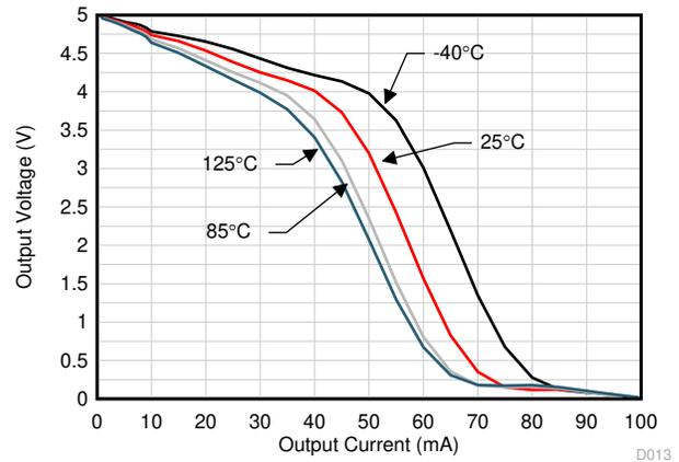
$V_S = 5\text{V}$ ,  $R_L$  を  $V_-$  に接続
