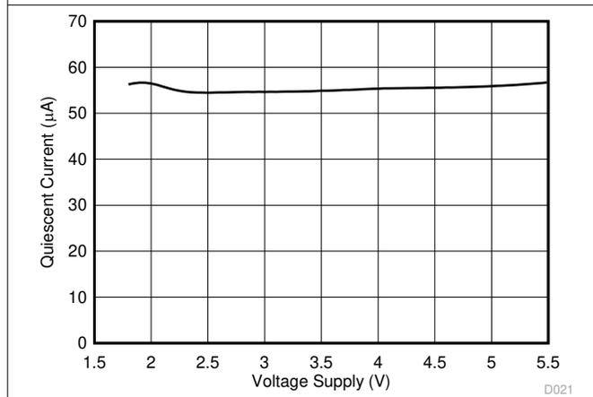
図 6-21. 静止電流と電源電圧との関係
