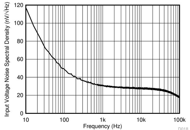
図 6-18. 入力電圧ノイズ スペクトル密度
