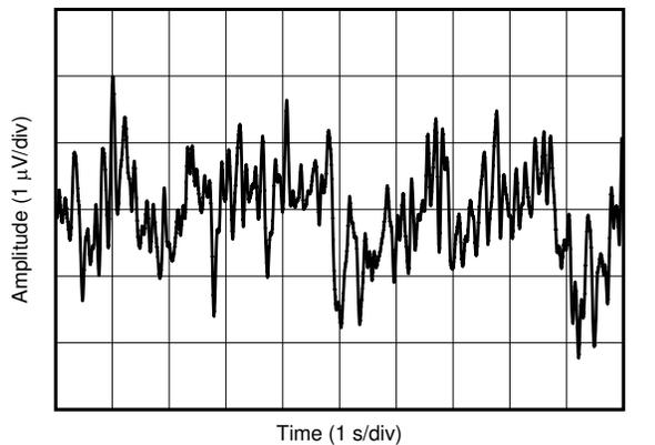
図 6-17. 0.1Hz~10Hz の積分電圧ノイズ
