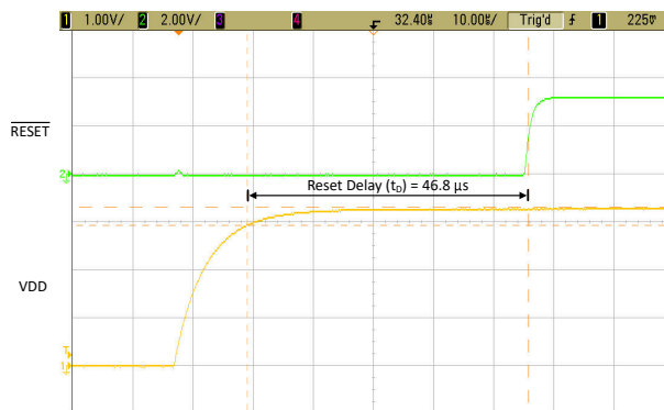
图 9-4. TLV841EVM RESET Time Delay ( t_D )
