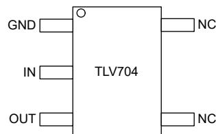
図 5-1. DBV Package, 5-Pin SOT-23 (Top View)
