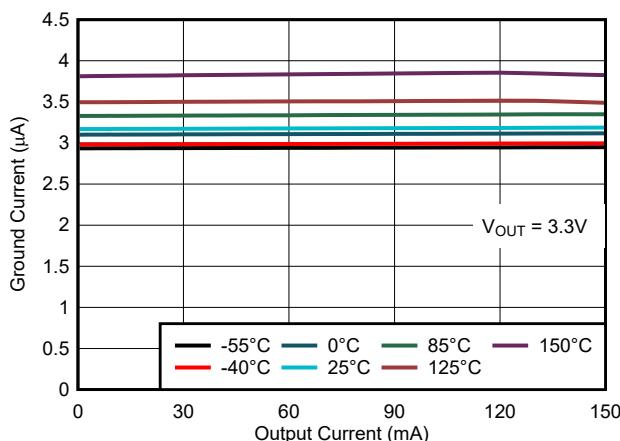
図 3-1. TLV704xx の静止時電流と負荷電流との関係
