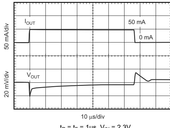
图 5-18. Load Transient Response
