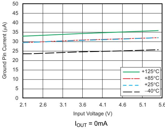
图 5-9. TLV70048-Q1 Ground Pin Current vs Input Voltage
