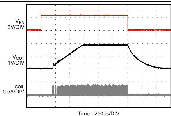
図 17. Startup with Load
