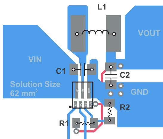
図 23. PCB Layout Recommendation
