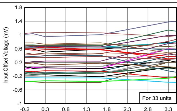
図 5-7. Offset vs. Common-Mode, 3.3V
