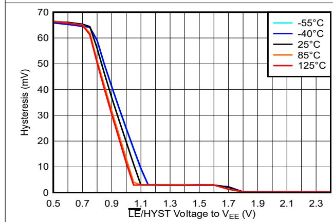
图 5-37. Hysteresis Voltage vs. LE/HYST Voltage, 3.3V
