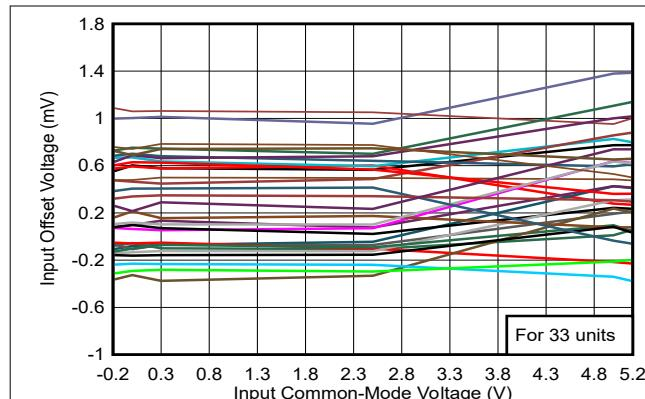
図 5-9. Offset vs. Common-Mode, 5V
