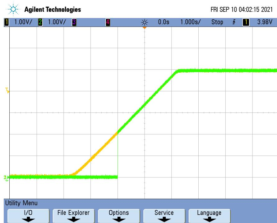
図 6-1. Output for  $V_{CC}$  Rising
