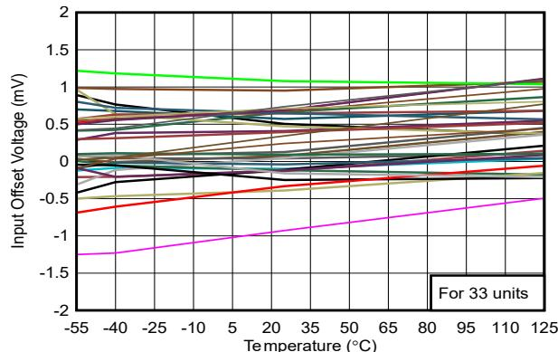
図 5-3. Offset vs. Temperature
