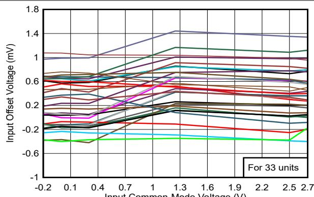
図 5-5. Offset vs. Common-Mode, 2.5V
