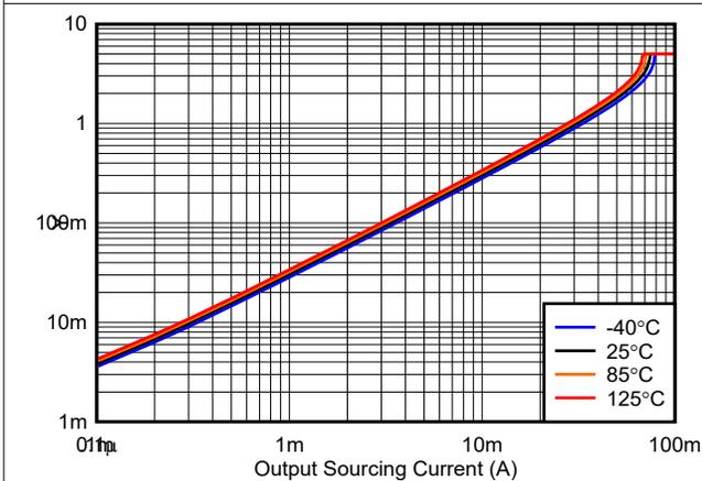
図 5-11. 出力電圧と出カソース電流の関係、5V
