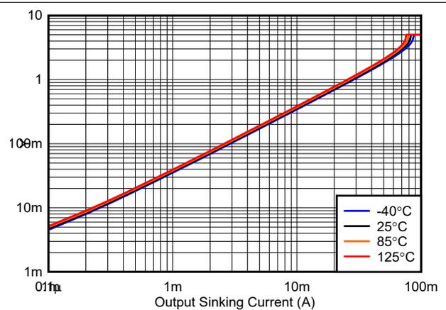
図 5-12. 出力電圧と出カシンク電流の関係、5V
