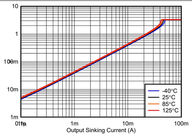
図 5-10. 出力電圧と出カシンク電流の関係、3.3V
