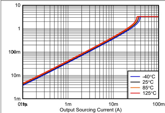
図 5-9. 出力電圧と出カソース電流の関係、3.3V
