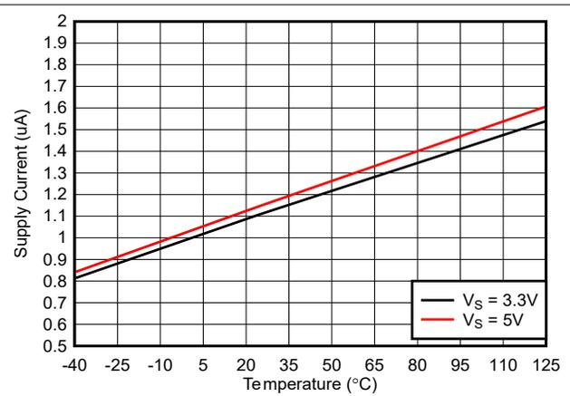
図 5-16. 電源電流と温度との関係 (出力 High)
