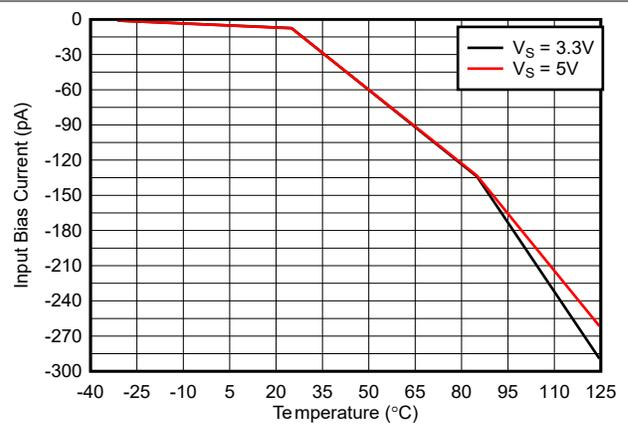
図 5-8. バイアス電流と温度との関係
