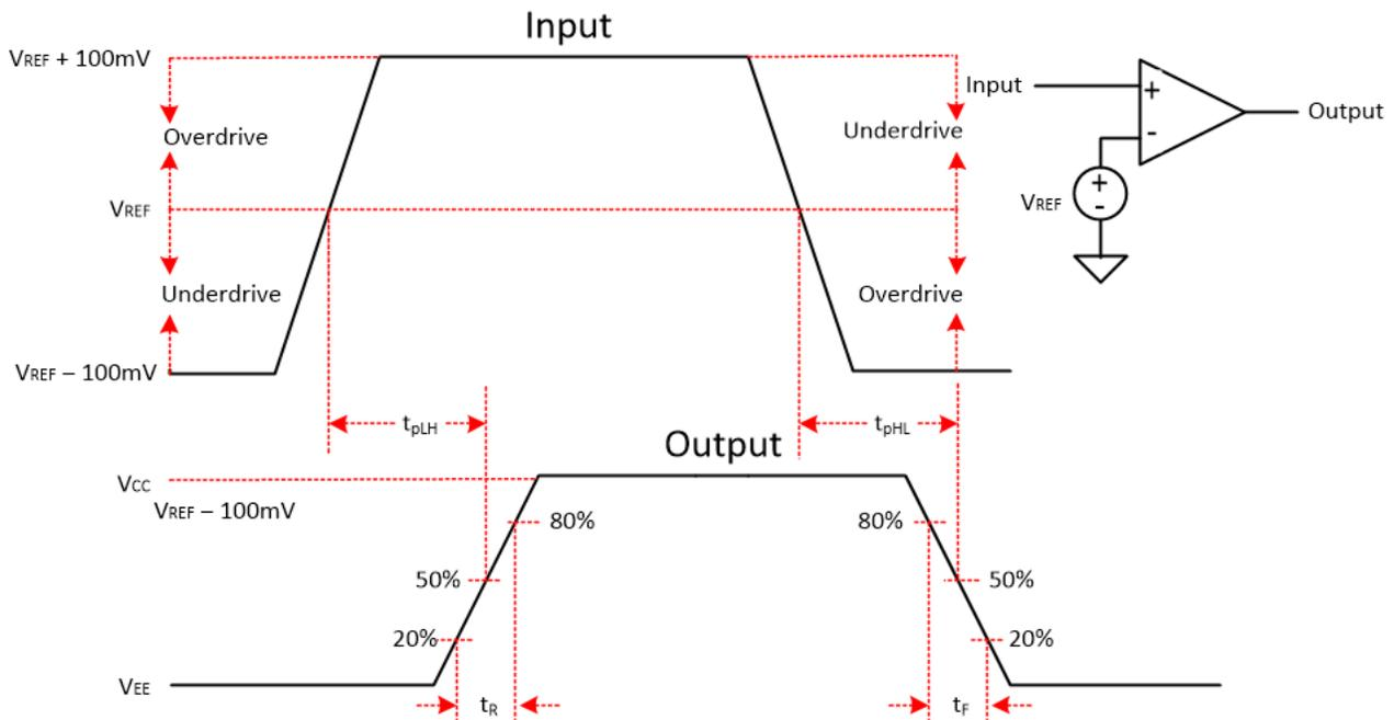
図 7-1. コンパレータのタイミング図
