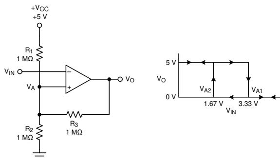
図 7-3. ヒステリシス付き反転構成の TLV3511-Q1
