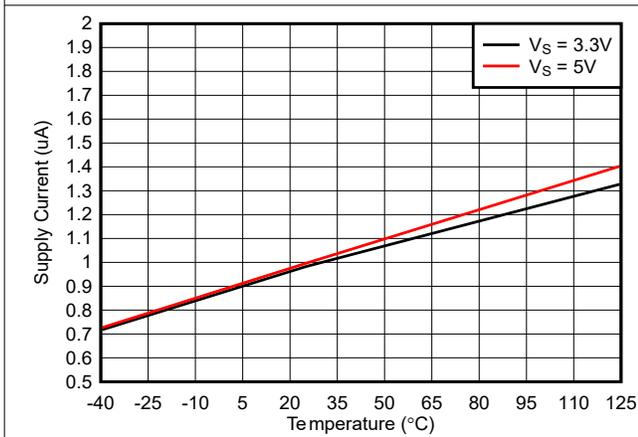
図 5-15. 電源電流と温度との関係 (出力 Low)
