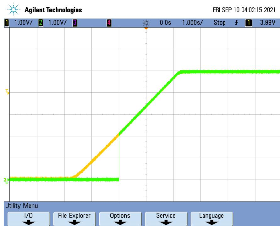
図 6-1. TLV1H103-SEP Output for  $V_{CC}$  Rising
