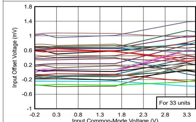
図 5-7. Offset vs. Common-Mode, 3.3V
