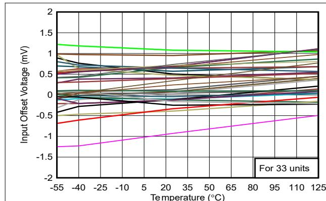
図 5-3. Offset vs. Temperature
