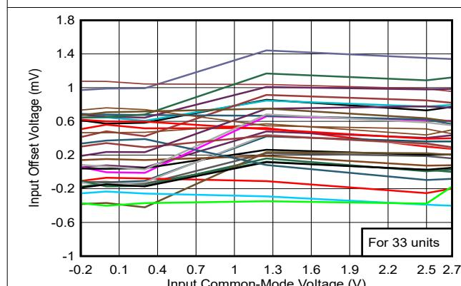
図 5-5. Offset vs. Common-Mode, 2.5V
