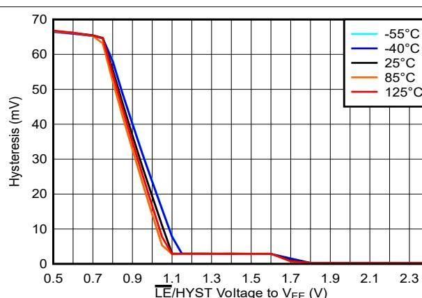
図 5-36. Hysteresis Voltage vs. LE/HYST Voltage, 2.5V
