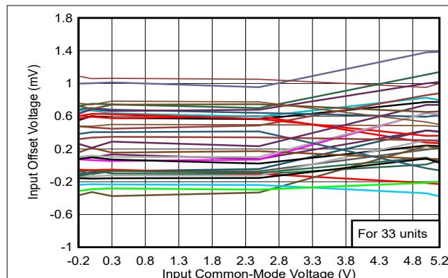
図 5-9. Offset vs. Common-Mode, 5V
