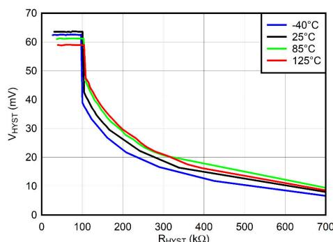
图 7-7.  $V_{HYST}$  vs.  $R_{HYST}$  at 5V curve
