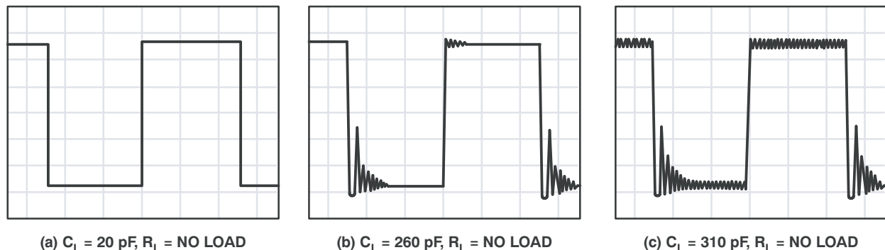
図 7-8. 低いバイアスモードでの容量性負荷の影響
