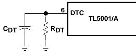
Figure 2. Soft-Start Circuit
